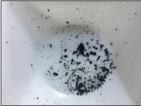
Resim 4.11. Membran reaktörde gerçekleştirilen etan dehidrojenasyonu sonucu oluşan karbon parçacıkları
