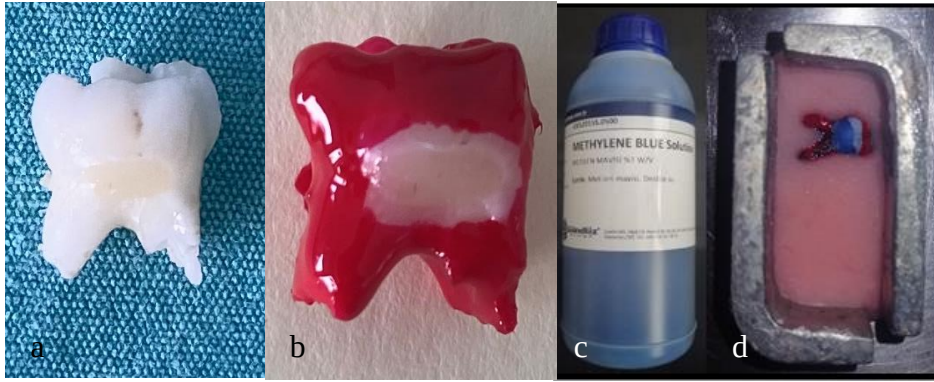
Resim 3.4. a) Polimerize edilmiş kompozit rezin, b) Ojelenmiş diş örneği c) Metilen mavisi, d) Metal kalıba yerleştirilmiş örnek
