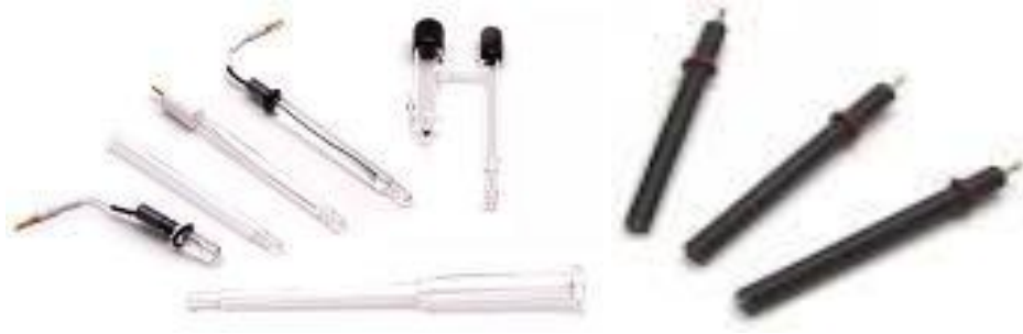
Resim 2.2. Voltametriye kullanılan elektrotlara örnekler
