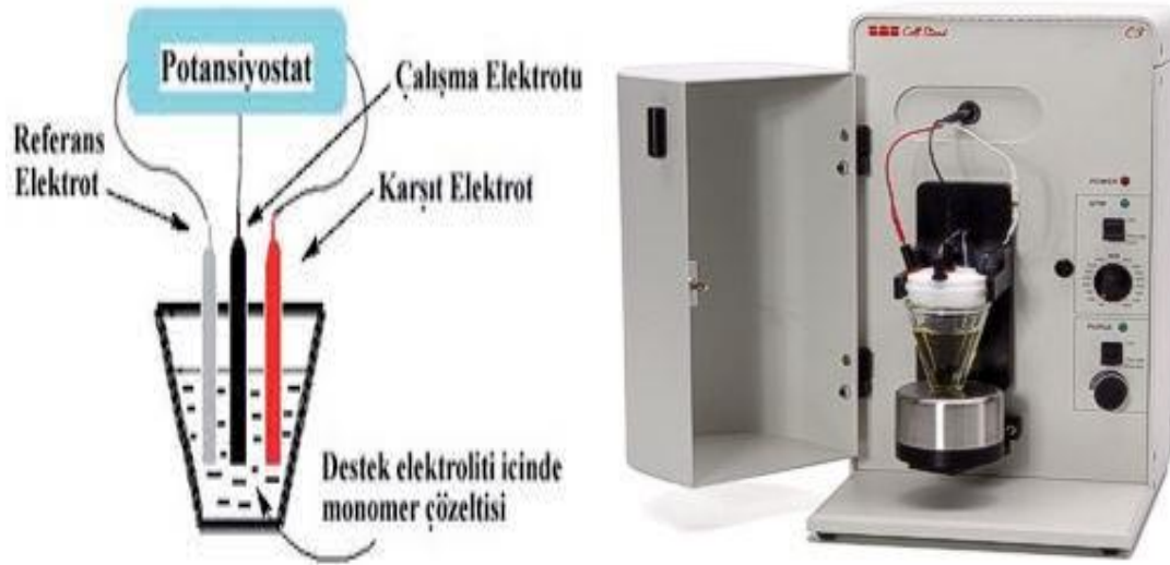
Resim 2.1. Voltametrik yöntemlerde hücre
