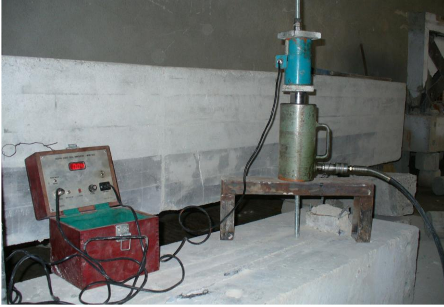
Resim 3.7. Kimyasal ankrajlara uygulanan çekme deneyi.
