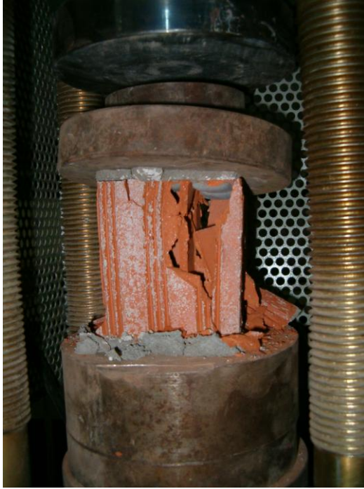
Resim 3.1. Tuğla birime basınç testi uygulanışı
