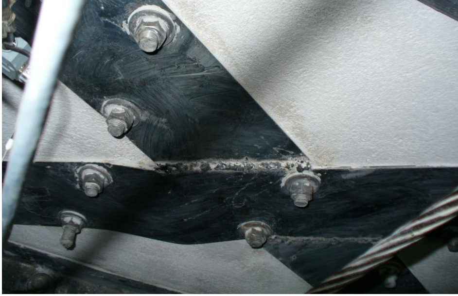
Resim 4.16. 19. çevrim sonrası burkulma detayı.
