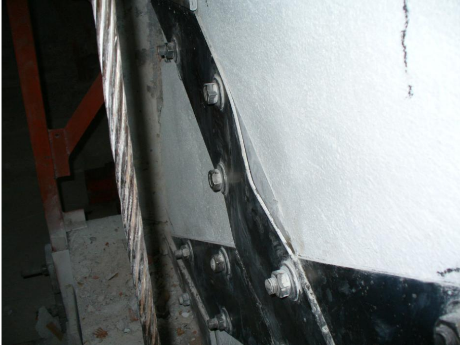
Resim 4.10. 15. ileri yarı çevrim sonrası arka yüzde burkulma detayı
