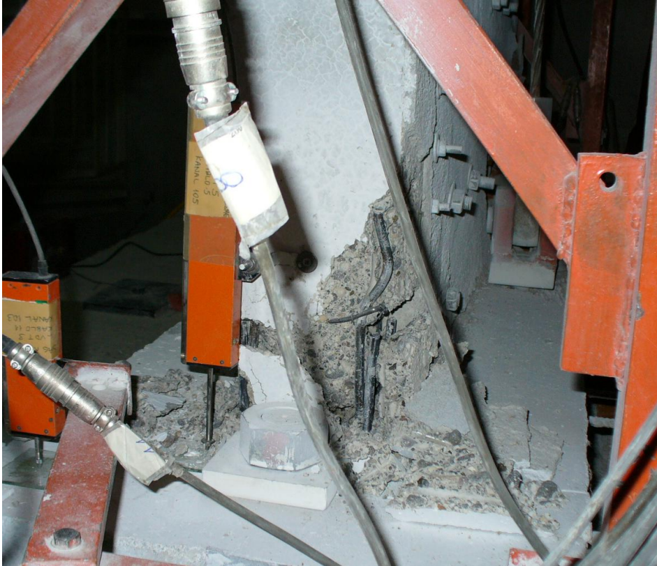
Resim 4.28. 21. çevrim sonunda saė kolon donatılarında gzlenen burkulma
