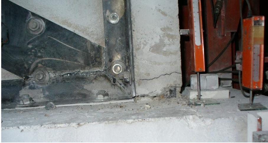
Resim 4.14. 13. çevrim sonrası meydana gelen kolon alt ucu ezilme detayı
