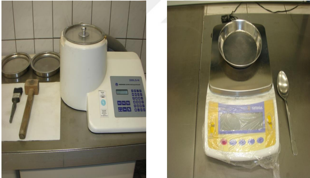
Resim 1.4. İncelik tayininde kullanılan Alpine incelik ölçüm cihazı ve Sartorius Basic elektronik terazi
