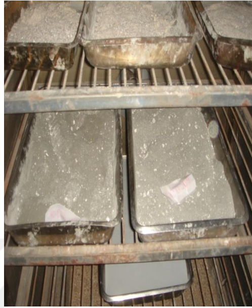
Resim 1.1. Tuğla tozunun öğütülmesinde kullanılan çene kırıcı ve örneklerin etüvde kurutulması
