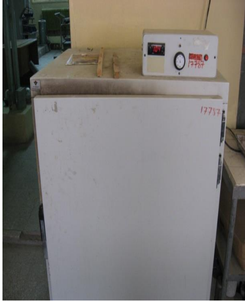
Resim 1.12. Yüksek sıcaklık öncesi örneklerin etüv fırınında kurutulması ve Yüksek sıcaklık fırınından bir görünüm.
