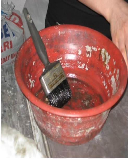
Resim 1.9. Harç karışımlarının kalıplara yağlanarak konulması.
