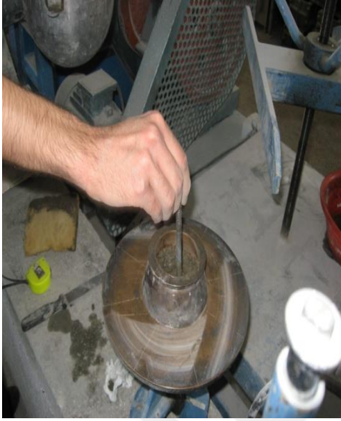
Resim 1.7. Harçların su ihtiyacının tespit edilmesi
