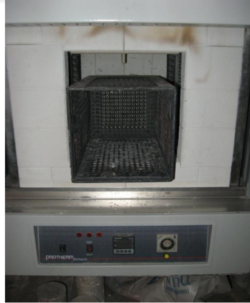
Resim 1.12. Yüksek sıcaklık öncesi örneklerin etüv fırınında kurutulması ve Yüksek sıcaklık fırınından bir görünüm.
