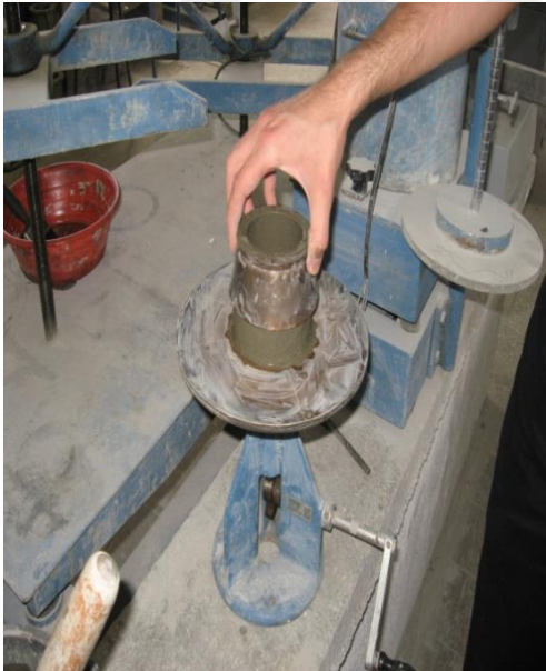
Resim 1.8. Harçların sarsma tablasındaki akma miktarının tespit edilmesi
