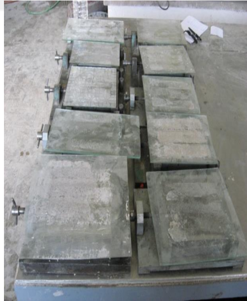
Resim 1.10. Harç karışımlarının kalıplara yerleştirilmesi.
