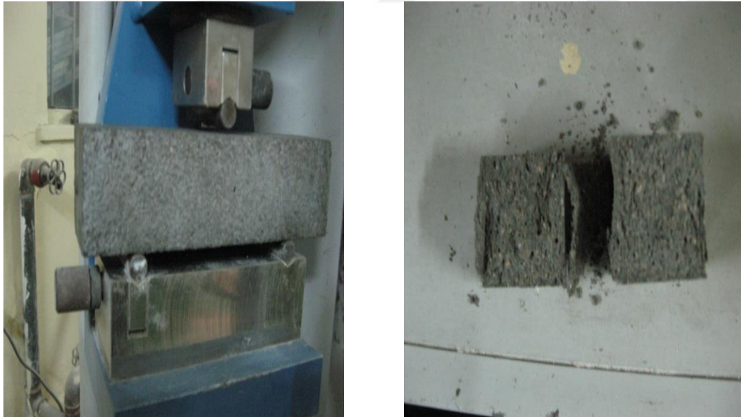
Resim 1.14. Harç örneklerinin eğilmede çekme deneyi
