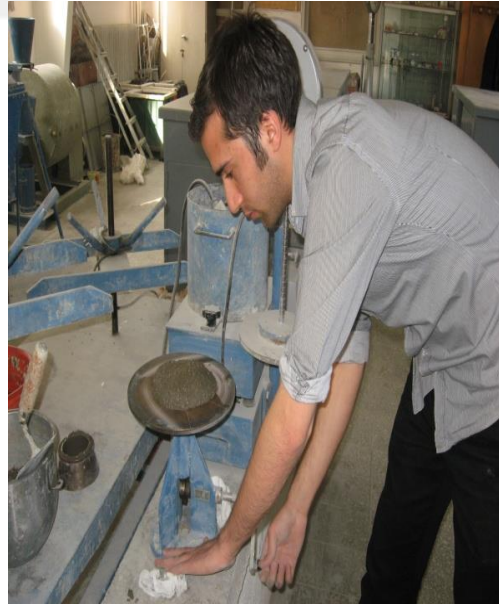
Resim 1.8. Harçların sarsma tablasındaki akma miktarının tespit edilmesi
