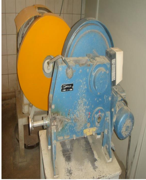
Resim 1.1. Tuğla tozunun öğütülmesinde kullanılan çene kırıcı ve örneklerin etüvde kurutulması
