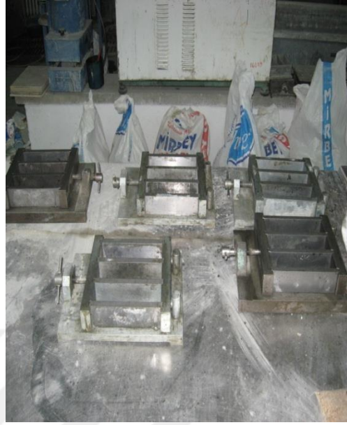
Resim 1.9. Harç karışımlarının kalıplara yağlanarak konulması.
