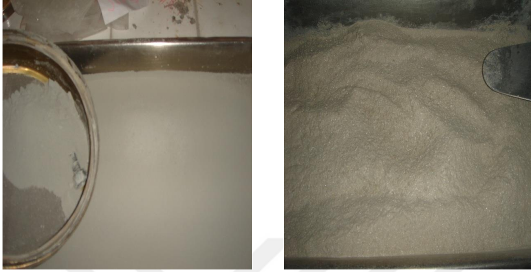
Resim 1.3. Örnek çimento tiplerinin öğütüldükten sonra elenmesi
