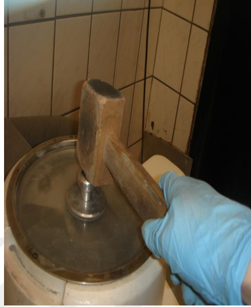
Resim 1.5. İncelik deneyinin yapılışı ve Micromeritics AccuPyc yoğunluk cihazı
