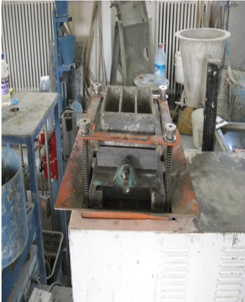
Resim 1.10. Harç karışımlarının kalıplara yerleştirilmesi.
