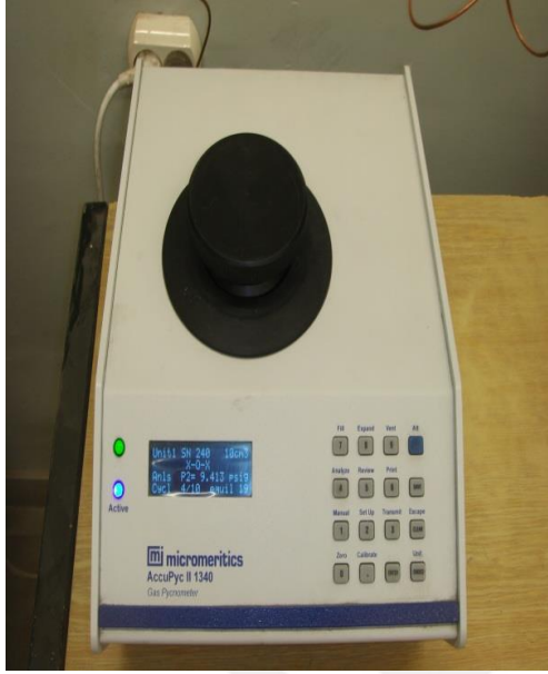
Resim 1.5. İncelik deneyinin yapılışı ve Micromeritics AccuPyc yoğunluk cihazı
