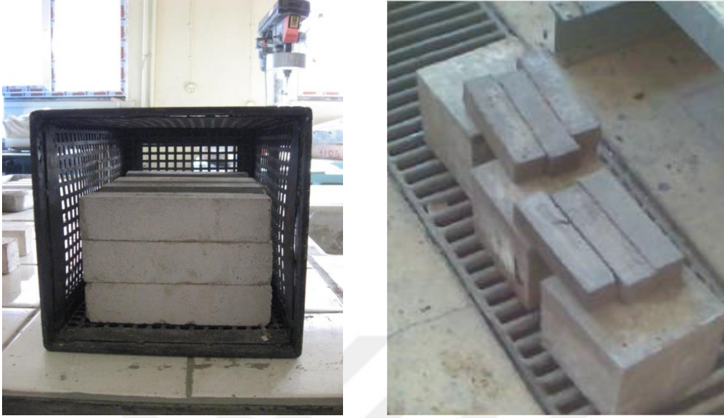
Resim 1.13. Harç örneklerinin yüksek sıcaklık fırınına yerleştirilmesi ve harç örneklerinin soğutma süreci.
