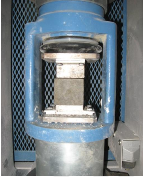
Resim 1.15. Harç örneklerinin basınç deneyi
