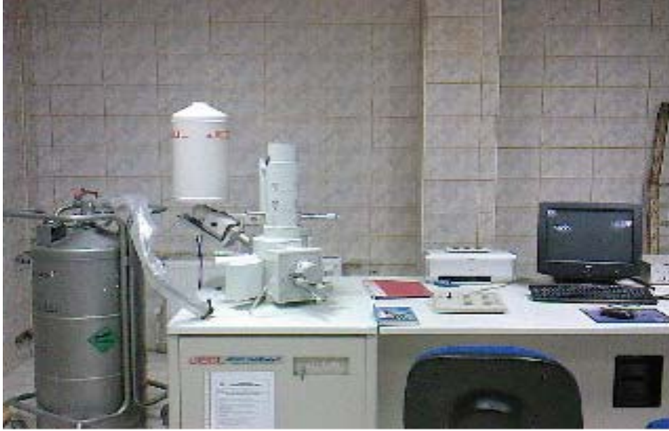
Resim 6.2. JEOL JSM-6360LV Taramalı elektron mikroskobu (SEM)
