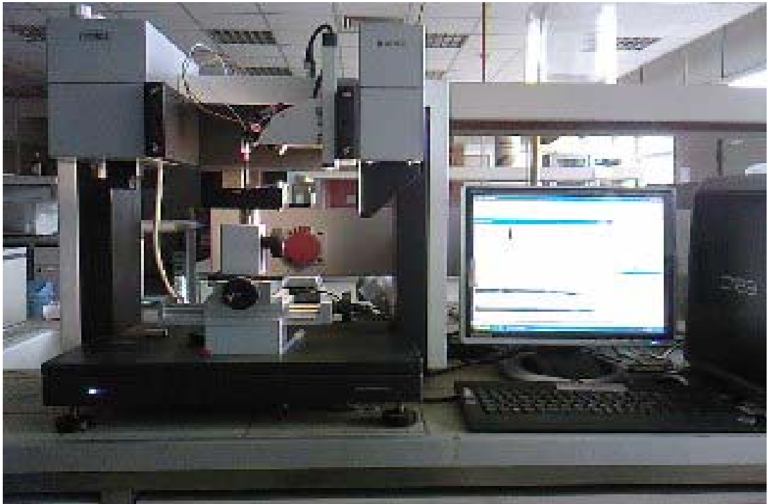
Resim 6.1. DSA100 Temas açısı ölçüm cihazı
