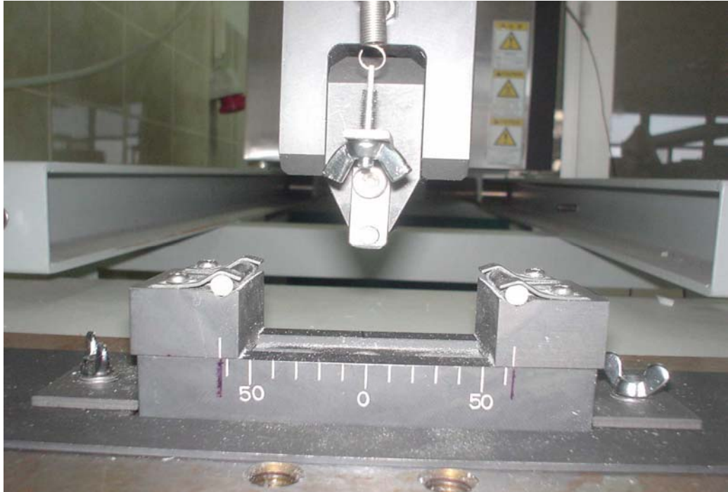
Resim 4.2. Üç noktadan eğme testi cihazı, span aralığı
