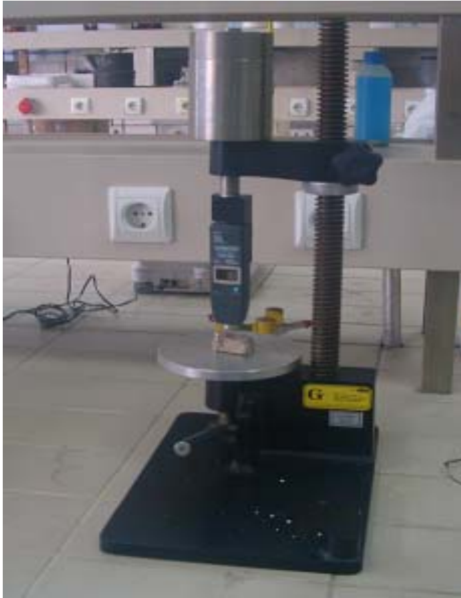
Resim 4.3. Shore sertlik ölçme cihazı
