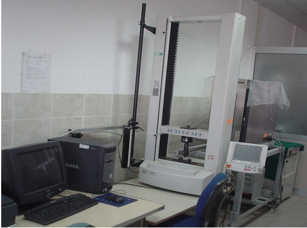
Resim 4.1. Bilgisayar destekli üç noktadan eğme testi cihazı
