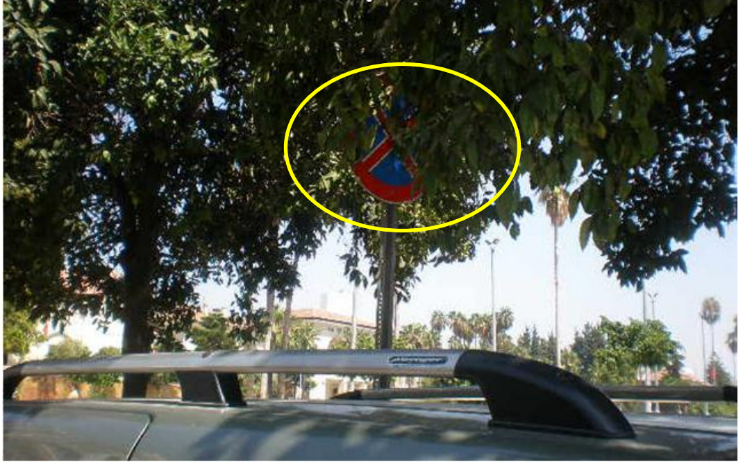
Resim 2: Trafik levhasının ağaçlar tarafından kapatılması sonucu görünürlüğünün azalmasını gösterir fotoğraf Mersin, Türkiye.
