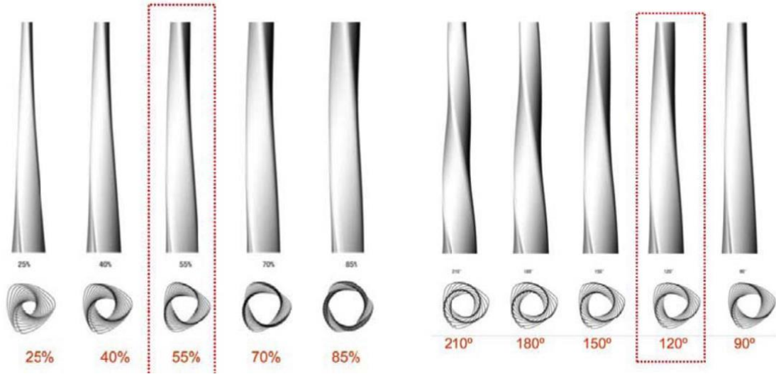
Resim 4.2. Rüzgâr tüneli çalışması ölçek ve rotasyon modelleri, (Faia, 2013)
