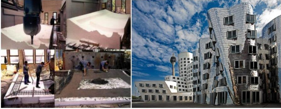
Resim 3.13. Zollhof Towers in Dusseldorf, Almanya, Gehry, 1999. Beton panellerin kalıbı için köpüğün oyulması, (URL- 5)
