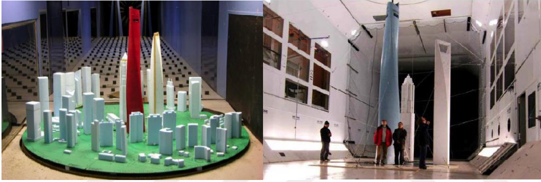
Resim 4.10. 1:500 ve 1:85 model üzerinde rüzgâr testleri (Faia, 2013)
