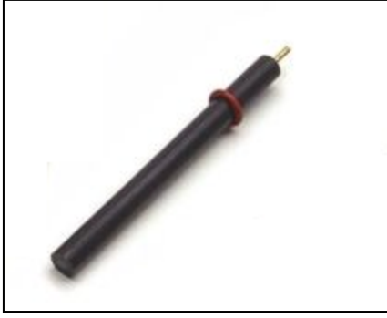
Şekil 3.1. Camsı karbon elektrot
