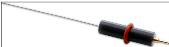
Şekil 3.3. Karşıt elektrot olarak kullanılan platin tel
