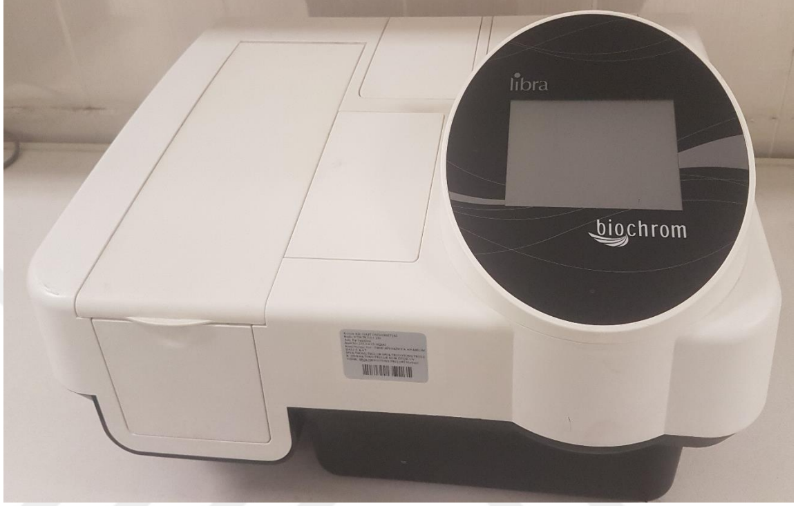
Şekil 1: Spektrofotometre (Libra S70 marka; Biochrom Ltd, Cambridge, England)
