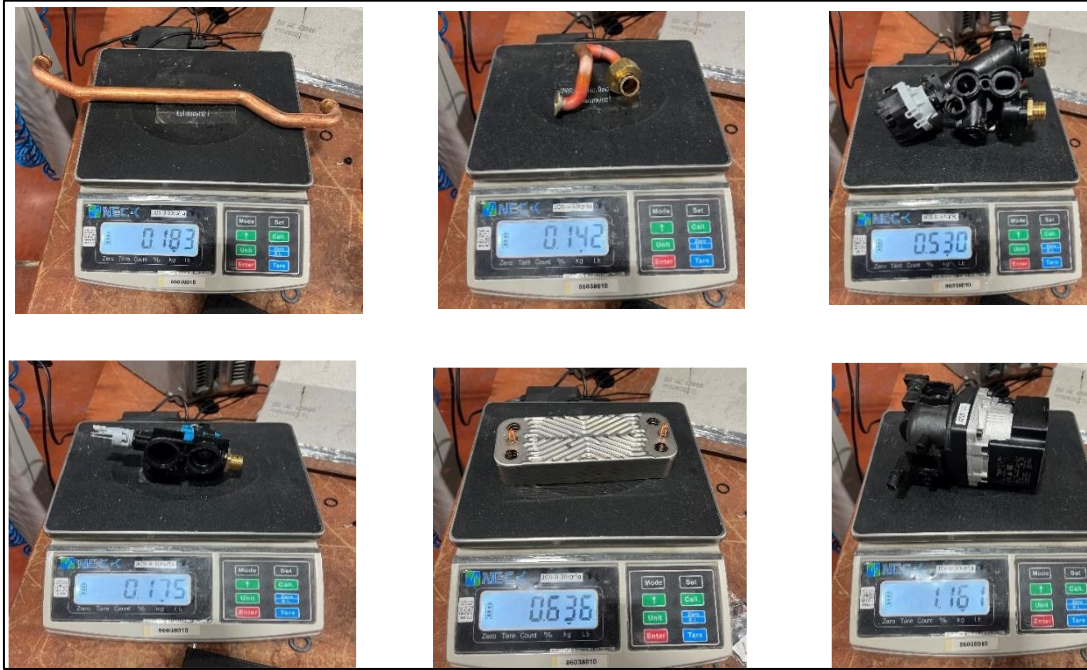
Resim 4.21. Testler öncesi komponent ağırlık ölçümleri
