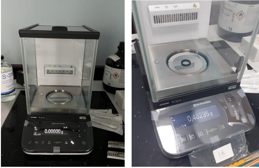
Resim 4.14. Hassas terazi ile hafif komponentlerin ağırlık ölçümü
