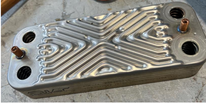
Resim 5.4. İyileştirilmiş kimyasal ile yapılan test sonrası plakalı eşanjör
