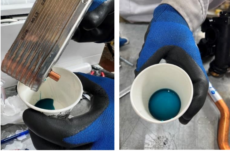
Resim 5.2. Plakalı eşanjör DHW çıkışında mavi sıvı
