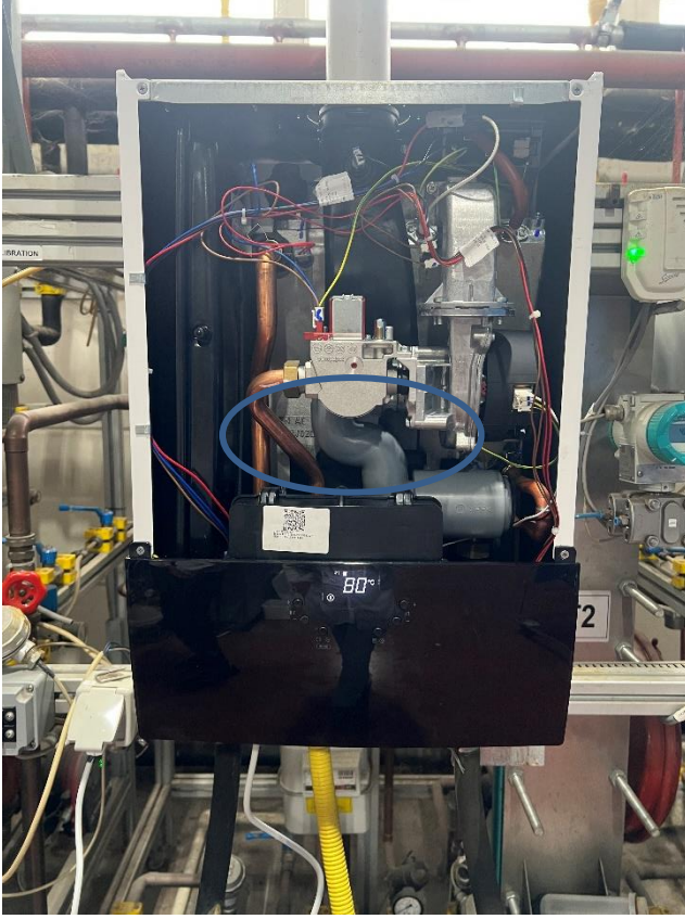
Resim 4.22. Testler sırasında sıcaklık parametresinin kombi üzerinde gösterimi
