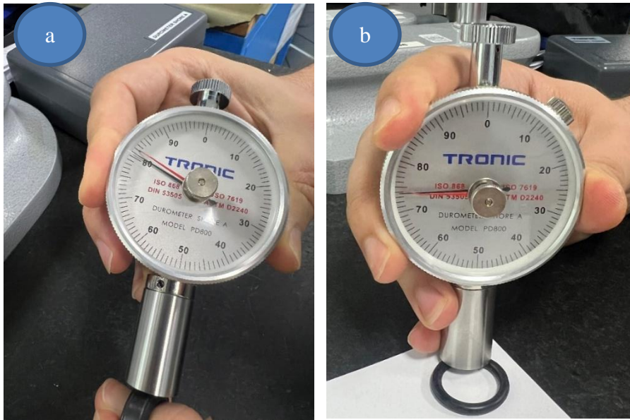
Resim 4.17. Çizelge 4.1'de yer alan birinci O-ring (a) ve onuncu O-ring (b) ait sertlik ölçümü
