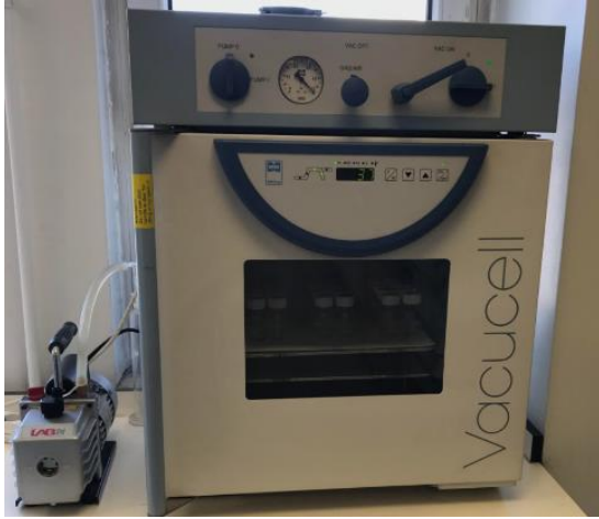
Resim 3.9. Etüv (VacuCell, MMM Medcenter)
