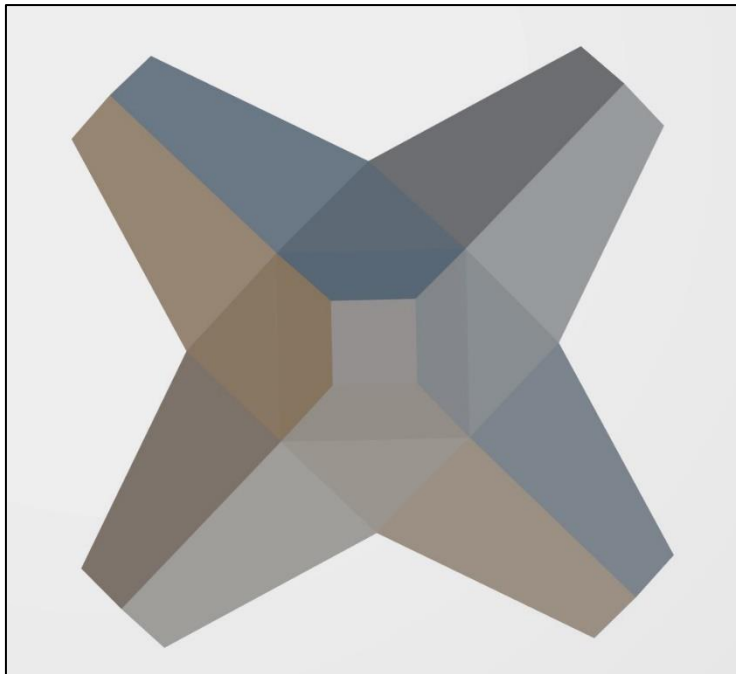
Şekil 6.1. Tezde geliştirilen Piblok+ tek sıra koruma tabakası
