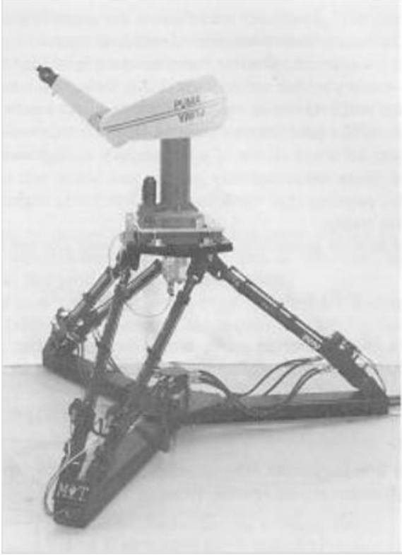
Şekil 2.19. Stewart platform manipulatör artı seri manipulatör [34]
