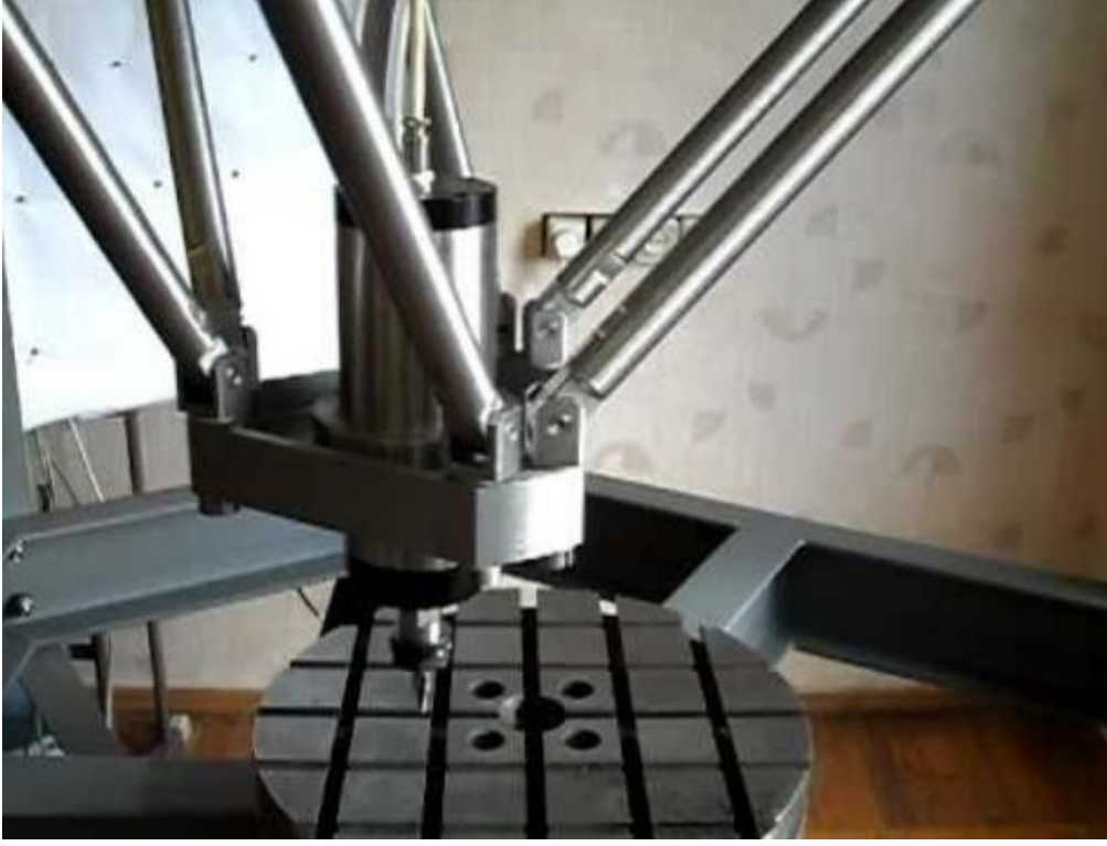
Şekil 2.23. CNC tezgahında SPM kullanımı [27]
