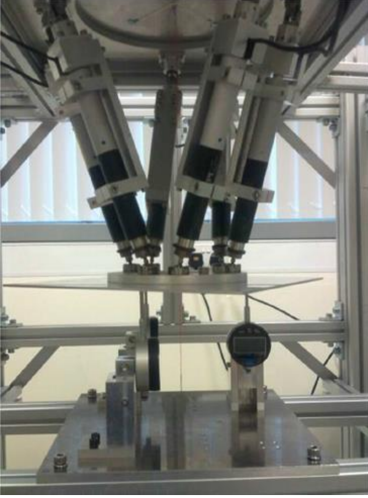
Şekil 2.22. Stewart Platformunun ölçüm cihazı olarak kullanımı [42]
