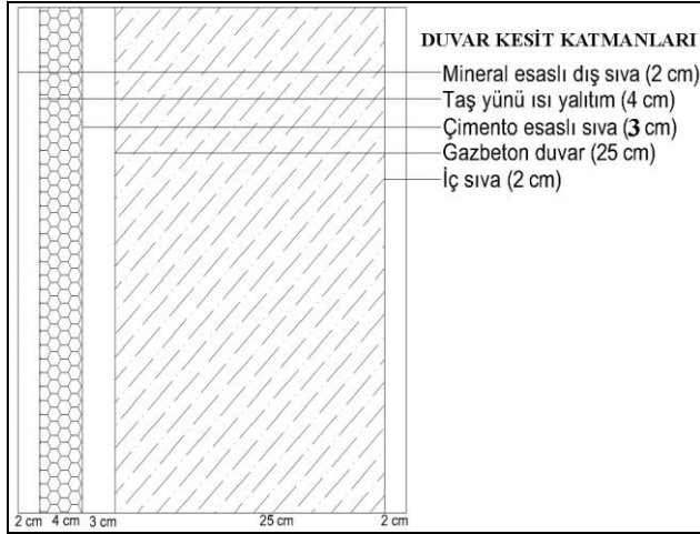
Şekil 4.11. Duvar kesiti ve katmanları
