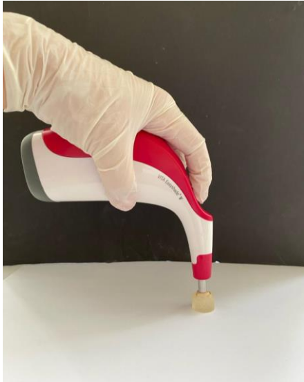
Resim 3.6. Test örneklerinin spektrofotometre ile renk ölçümü
