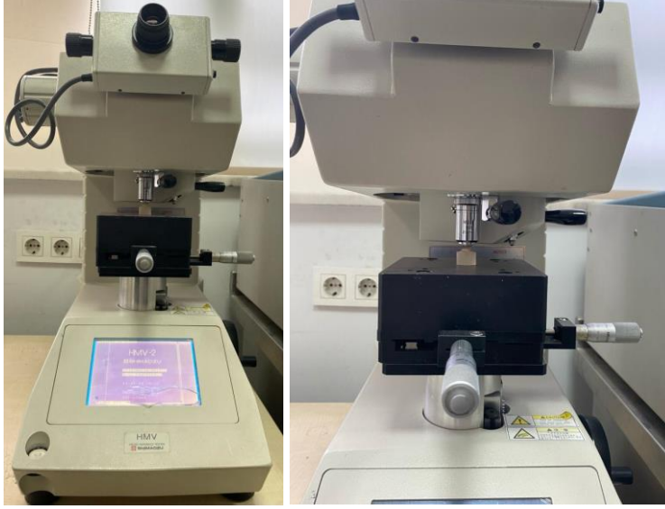
Resim 3.8. Test örneklerinin sertlik cihazı ile yüzey mikrosertlik ölçümü
