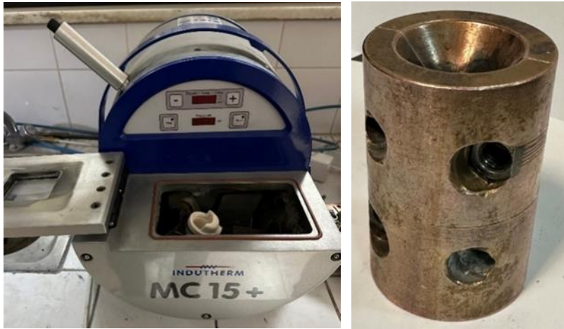
Resim 3.3. a) Indutherm MC15+ Vakum indüksiyon Cihazı b) Bakır döküm kalıbı
