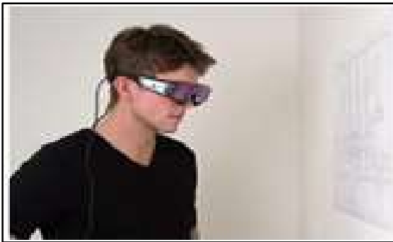
Resim 3.10. Takılabilir göz takip cihazı [77]
