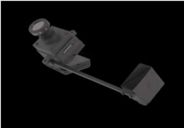
Resim 3.18. Smart eye pro göz takip cihazı [92]
