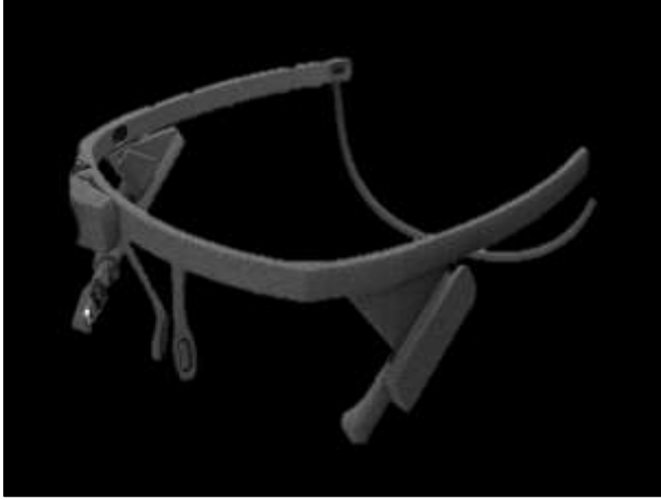
Resim 3.20. Pupil Labs core göz takip cihazı [95]
