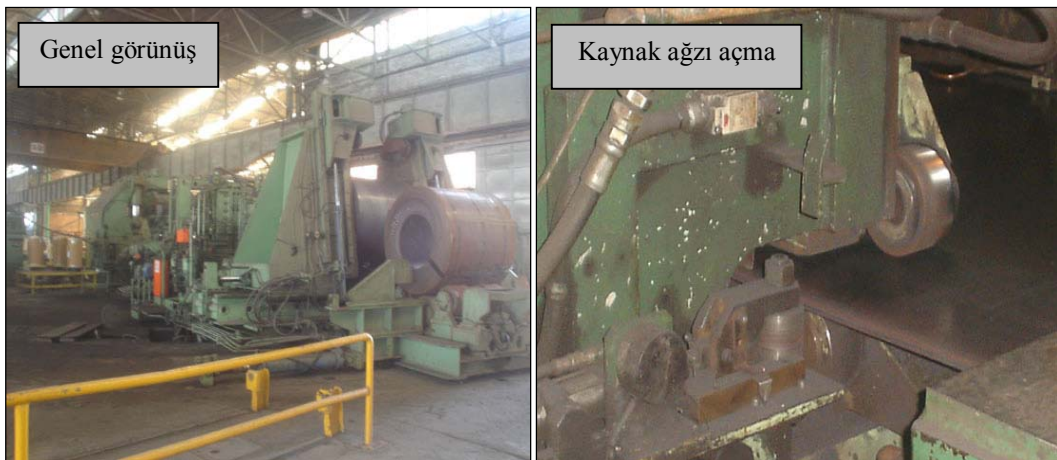
Resim 4.1. Spiral dikişli boru üretim makinesinin değişik aşamaları
