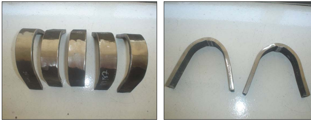
Resim 6.14. Eğme deneyi sonucunda numunelerin iki farklı açıdan görünüşü
