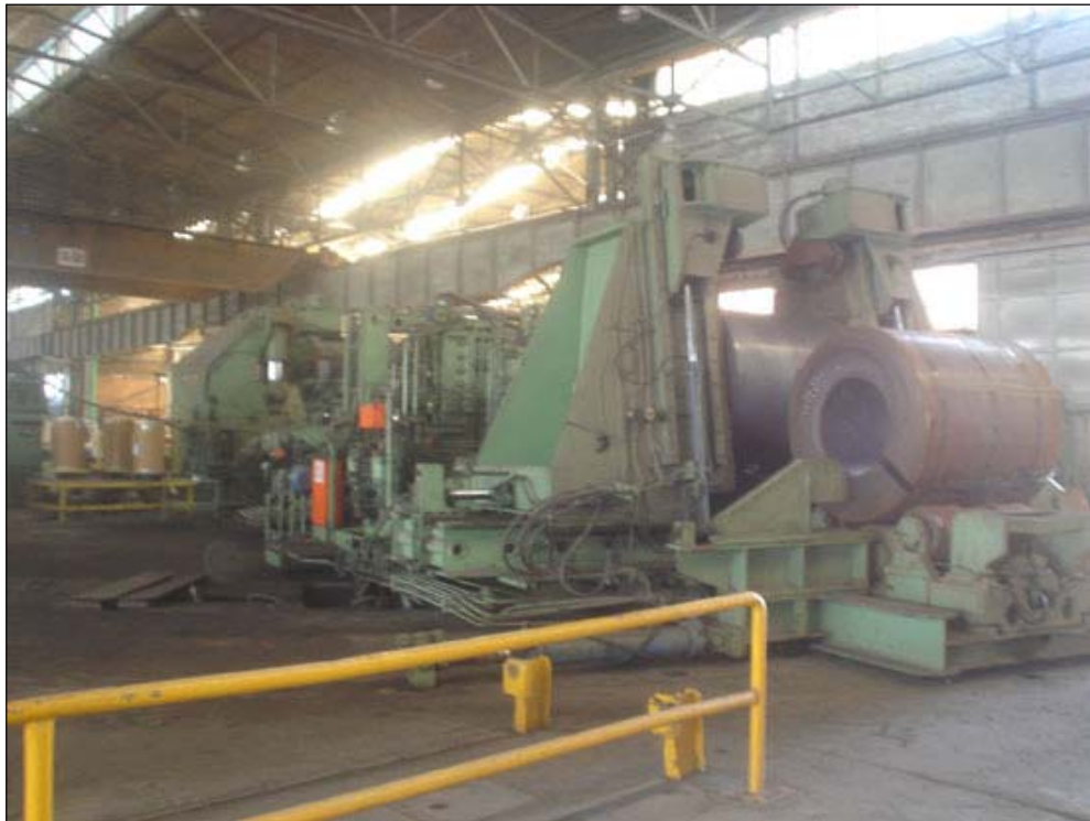
Resim 5.1. Spiral boru üretiminde kullanılan kaynak makinesi
