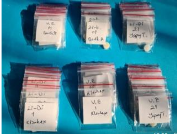
Resim 3.14. Solüsyonda bekletilmeden önce Ra ölçümleri yapılmış örnekler
