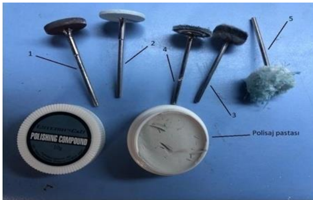
Resim 3.12. Çalışmada kullanılan polisaj patı ve frezler
