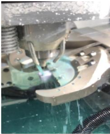
Resim 3.7. e.max-CAD blokların kazıma işlemi
