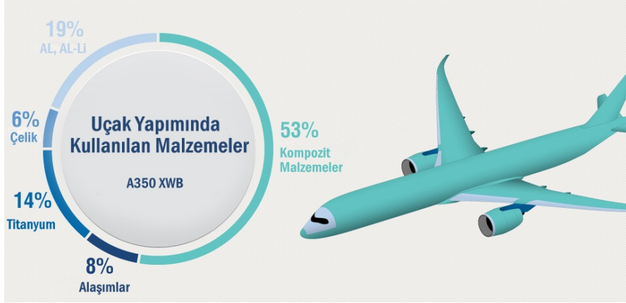
Şekil 1.1. Airbus A350 uçağında kompozit malzeme oranı [3]
