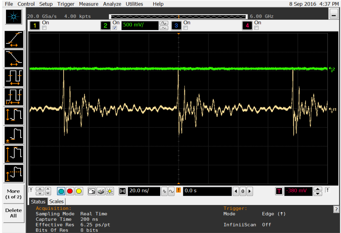
Resim 3.11. Antenlerden alınan sinyal ve elektronik kart çıkışında pik değerinin yakalanmasını gösteren Osiloskop ekran görüntüsü
