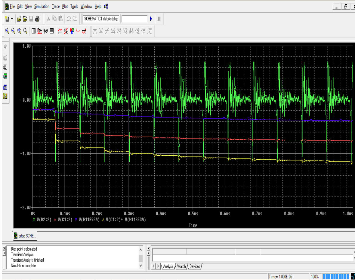
Resim 4. 3. Negatif pik yakalayıcı devre sonucunda elde edilen grafik
