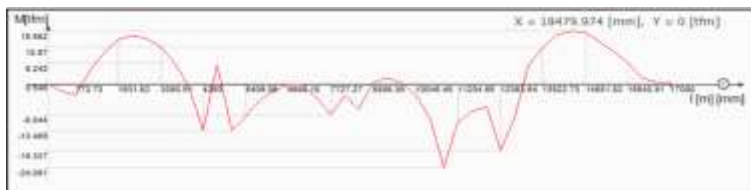
Şekil 7.6. 3 numaralı hesap aksı üzerinde çoklu eşlenik Winkler yay yöntemiyle elde edilen moment diyagramları
