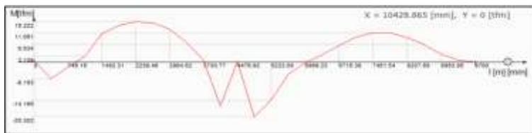
Şekil 7.17. 9 numaralı hesap aksı üzerinde üniform Winkler yay yöntemiyle elde edilen moment diyagramları
