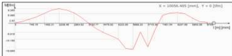
Şekil 7.14. 7 numaralı hesap aksı üzerinde çoklu eşlenik Winkler yay yöntemiyle elde edilen moment diyagramları
