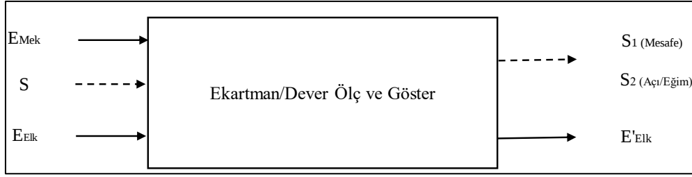
Şekil 3.2. Ekartman ve dever ölçüm aletine ait tüm fonksiyon şeması
