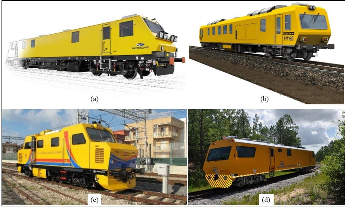
Resim 2.1. Yol kayıt araçları (TRV) a) Geismar Eye Dragon, b) Plasser-Theurer EM 160, c) Mermec Roger 400, d) Harscorail TGIV
