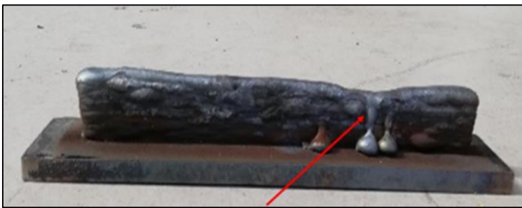
Resim 2.10. Aşırı ısı birikimi yüzünden duvarın çökmesi [44]
