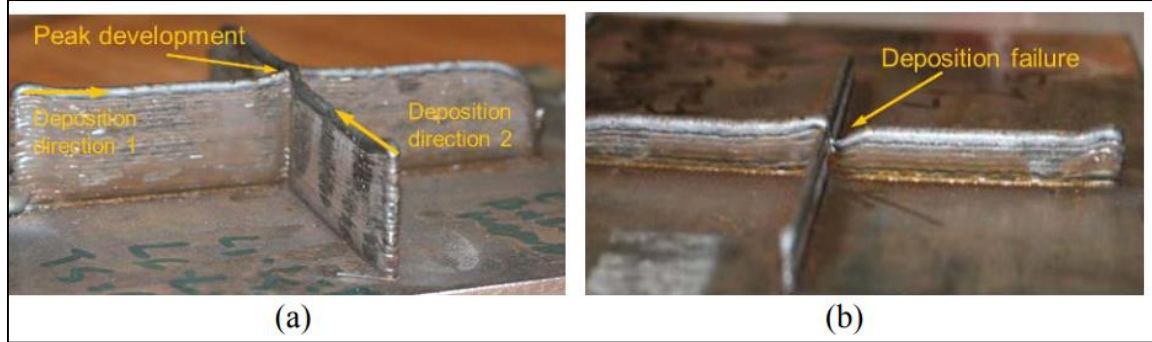
Resim 2.7. Kesişen cidarlardaki hatalar: a) tepeleme b) çökme [34]
