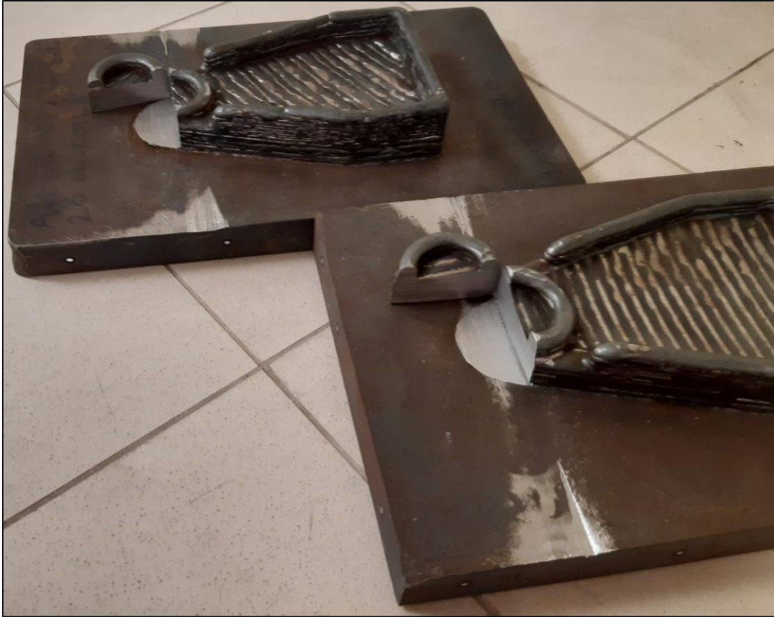
Resim 5.4. C kısmının ortasından olacak şekilde iki parçanın kesildiği yer
