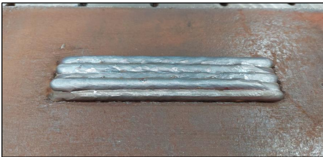
Resim 6.1. Modeli doğrulamak için yığılmış kutu şeklindeki parça
