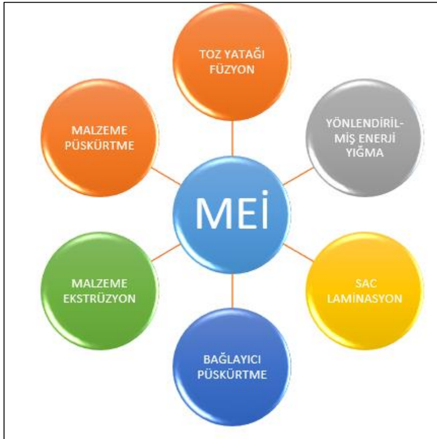
Şekil 2.1. Metal eklemeli imalat ana yöntemleri
