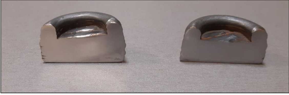
Resim 5.5. SR ile üretilen parçanın (solda) ve AR ile üretilen parçanın (sağda) kesiti
