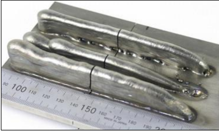
Resim 2.6. Yığman başlangıcında aşırı malzeme birikimi ve yığma sonunda ince duvarın çökmesi [31]
