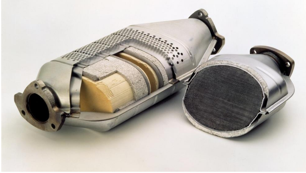
Resim 2.1. Katalitik konvertör iç yapısı [21]
