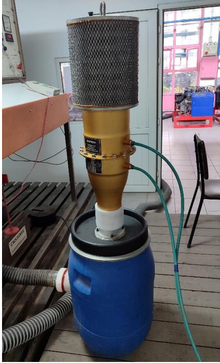
Resim 3.3. Meriam Z50MC2-4F hava akışmetresi ve sönümleyici tank
