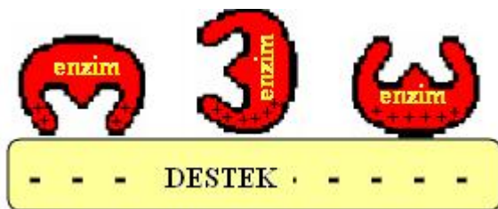
Şekil.2.15.Adsorpsiyon yöntemi ile immobilizasyonun gösterimi
