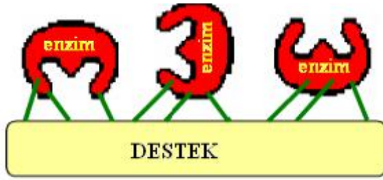
Şekil 2.13.Kovalent Bağlanma ile İmmobilizasyonunun Gösterimi
