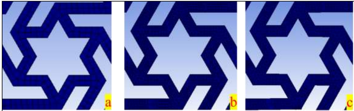
Şekil 5.18. 6 yıldız mozaik auxetic yapının ayarlanabilir meshli kafes yapı görünümü (a) %20 ayarlaması mesh modeli (b) %5 ayarlamalı mesh modeli (c) %0 ayarlamalı mesh modeli
