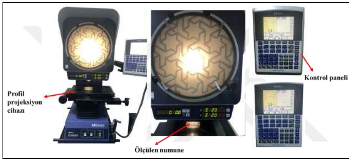
Resim 5.1. Profil projeksiyon ile numune ölçümleri
