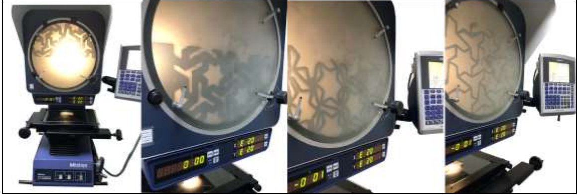
Resim 8.2. Numunelerin deney sonrası profil projeksiyon ile ölçülmesi
