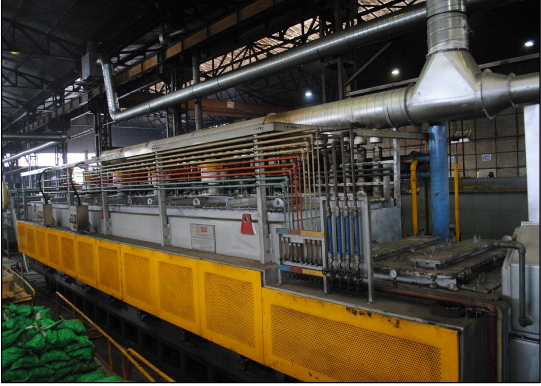
Resim 1.16. Sertleştirme fırını önden görünüşü
