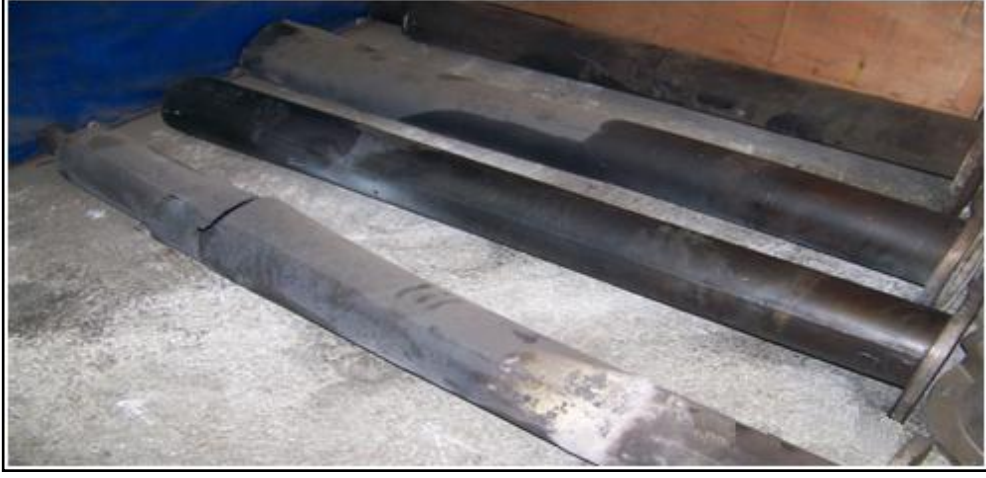
Resim 2.1. Aç-kapa kumanda edilen brülör tüpleri
