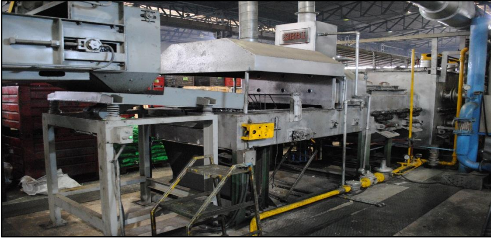
Resim 1.5. Sertleştirme fırını yükleme girişi
