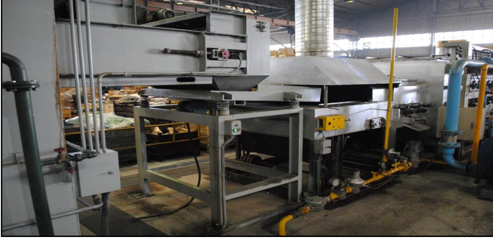
Resim 1.13. Menevişleme fırını yükleme girişi
