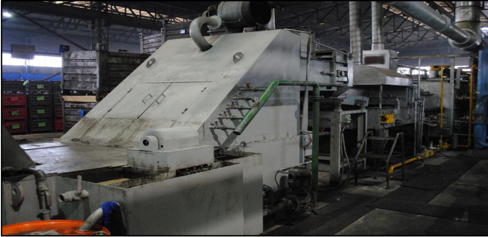
Resim 1.3. Serleştirme firması öncesi alkali deterjanla yıkama ünitesi
