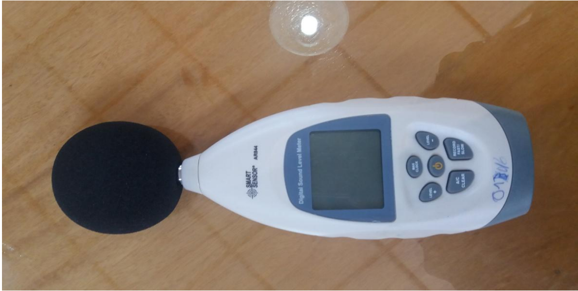
Resim 4.3. Gürültü ölçüm cihazı
