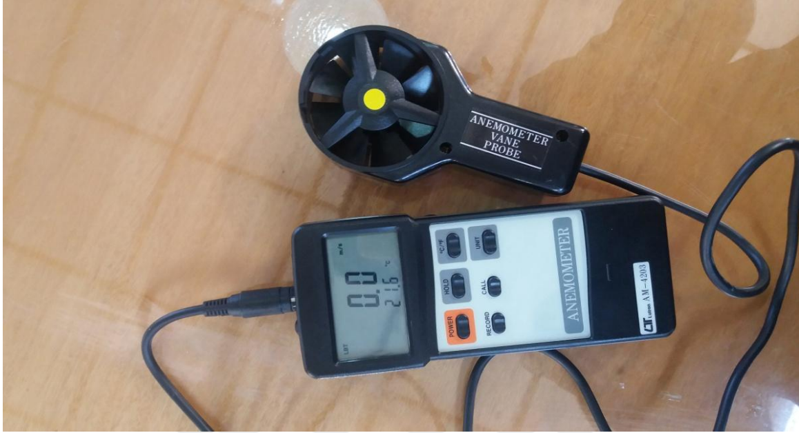
Resim 4.6. Hava akım hızı ölçüm cihazı
