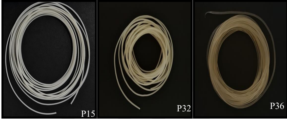
Resim 4.1. Eudragit S100 (P15), HPMCAS (P32) ve etil selüloz (P36) bazlı plasebo filamentlere ait görseller
