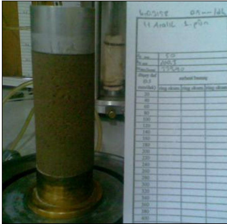
Resim 8.2. Beklemesi biten numunelerin serbest basınç dayanım deneyi
