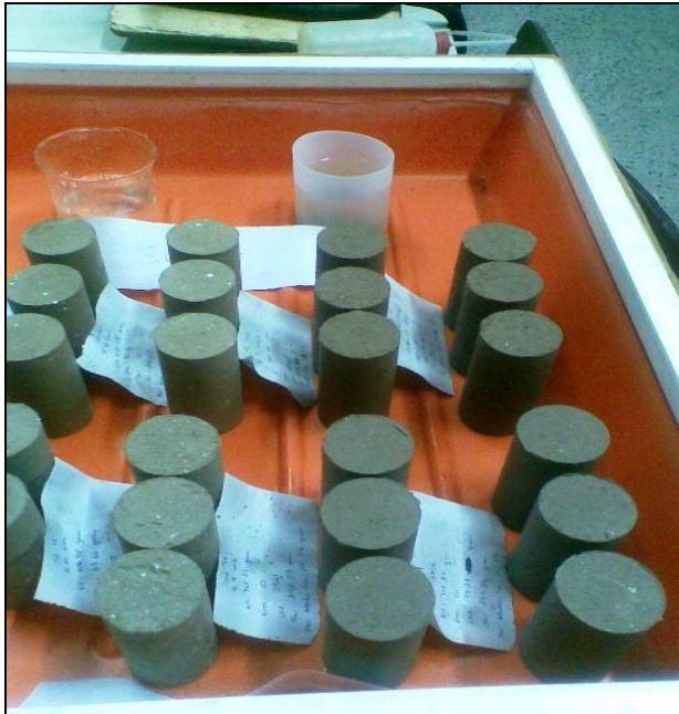
Resim 8.1. Değişik kireç oranlarında hazırlanan serbest basınç dayanım deney numuneleri
