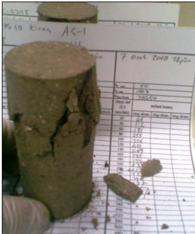
Resim 8.3. Serbest basınç dayanım deneyi sonunda kırılan numune
