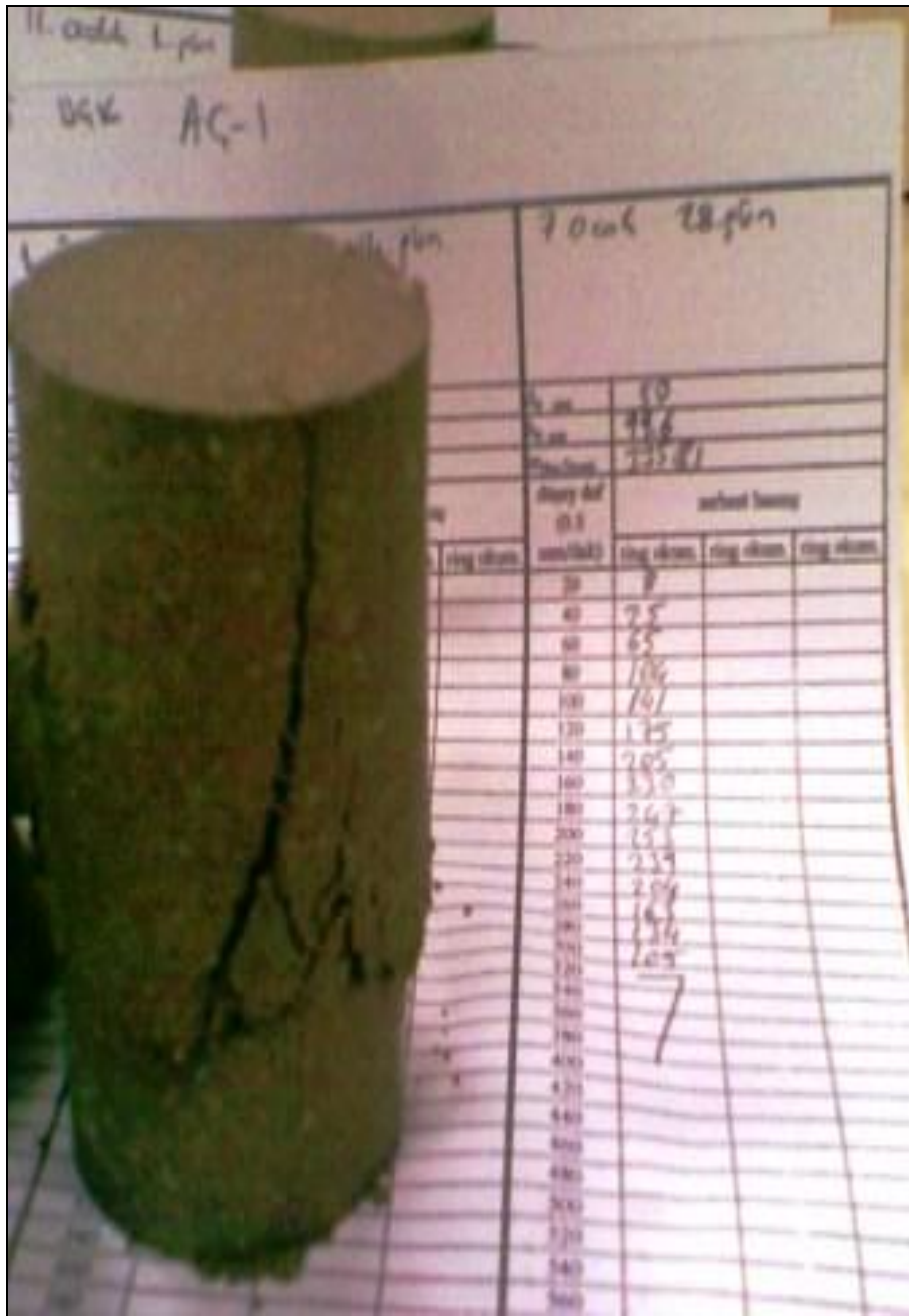
Resim 8.5. Serbest basınç dayanım deneyi sonunda kırılan numune
