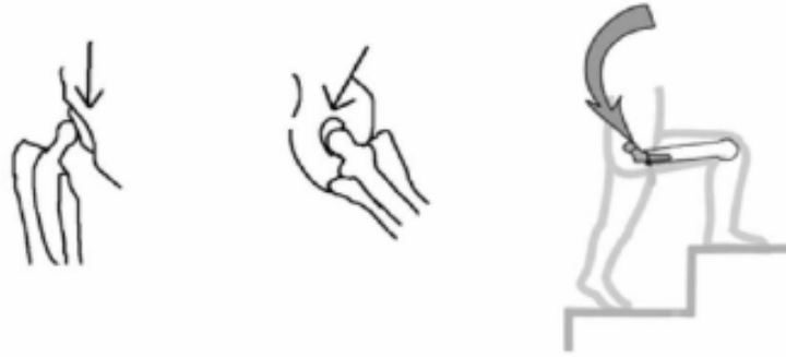
Şekil 37. Kalça eklemi ve protez üzerine sagittal ve koronal düzlemde etki eden kuvvetler ve rotasyonel kuvvetler.
