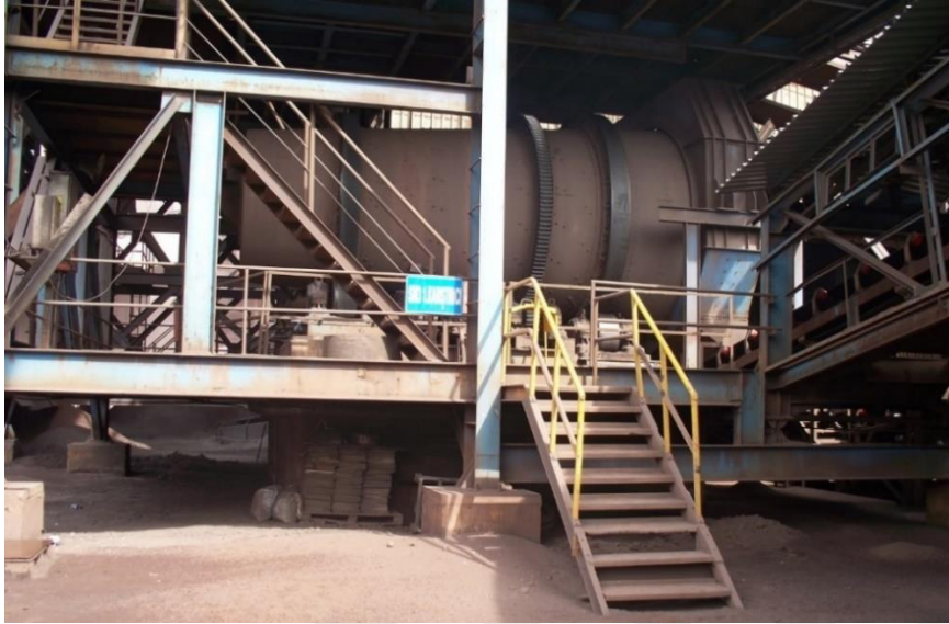
Resim 6.1. Sinter kuru karıştırıcı
