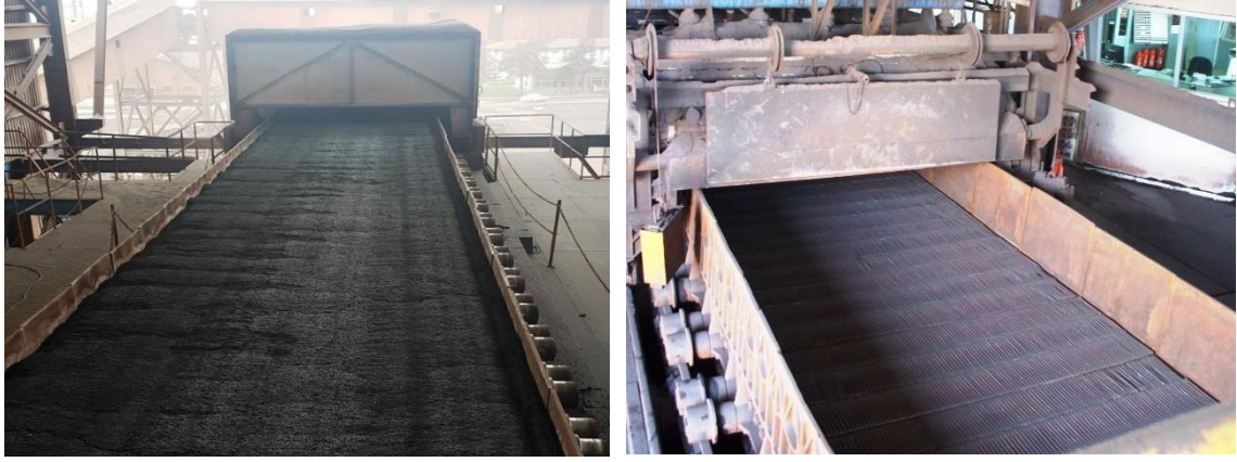
Resim 6.2. Sinter palet ve ızgaraları
