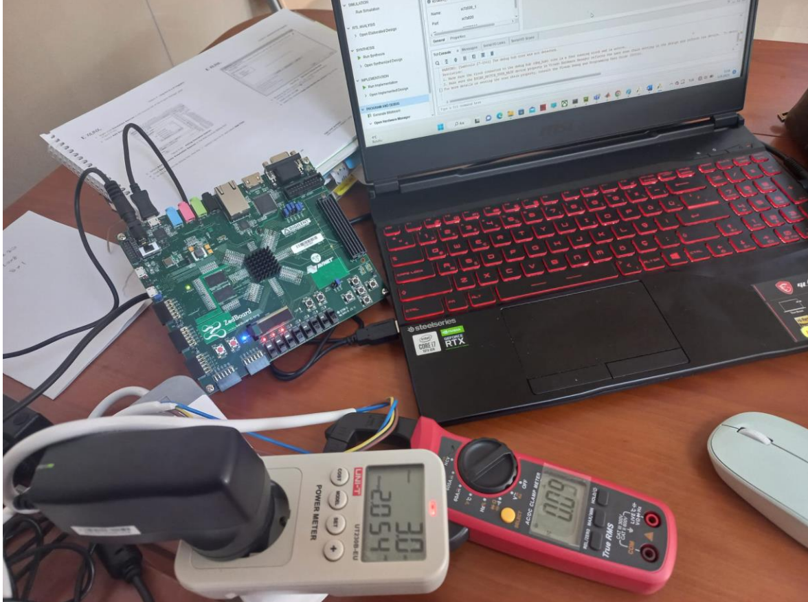
Şekil 8.19. ZedBoard FPGA geliştirme kartı-dizüstü bilgisayar bağlantısı ve UT230B-EU güç ölçüm cihazı kullanılarak FPGA için yapılan güç ölçümü
