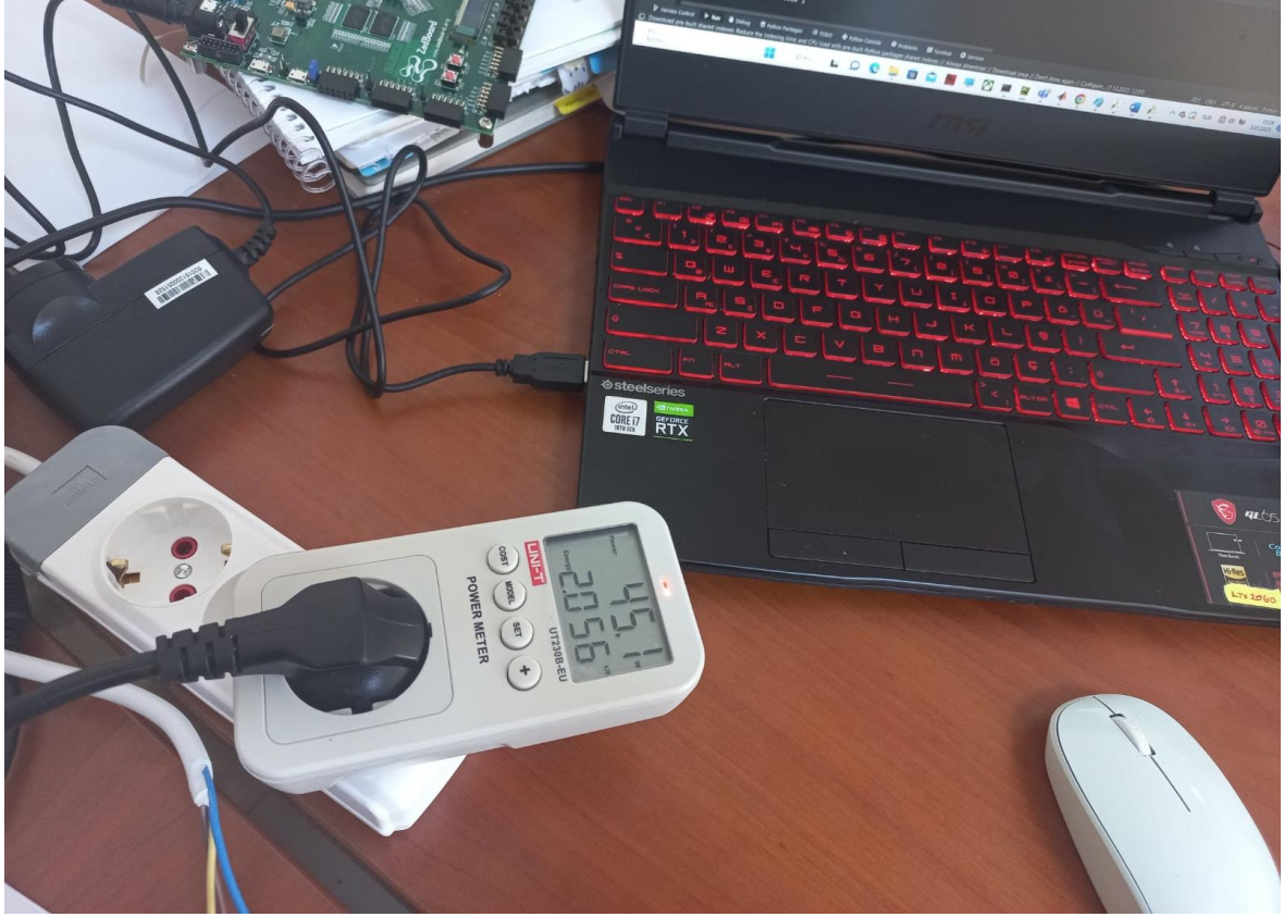
Şekil 8.20. Yazılım çıkarım aşamasında dizüstü bilgisayar için yapılan güç ölçümü
