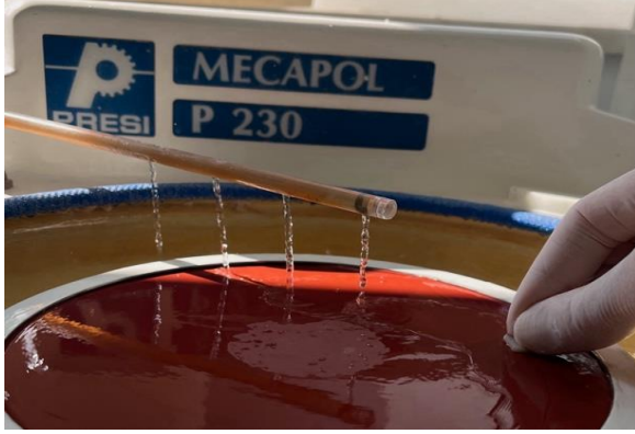
Resim 3.3. Zımparalama ve polisaj cihazında örnekler zımparalama uygulaması
