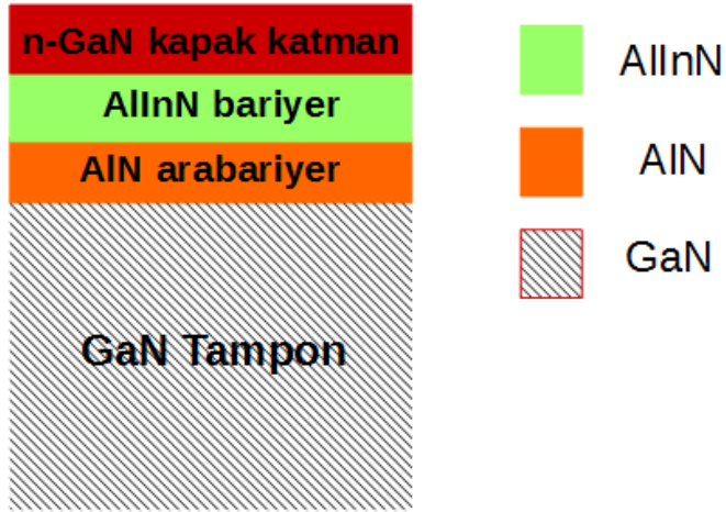
Şekil 5.1. n-GaN/InAlN/AlN ultraince bariyerli çokluyapısının (Yapı1) şematik gösterimi
