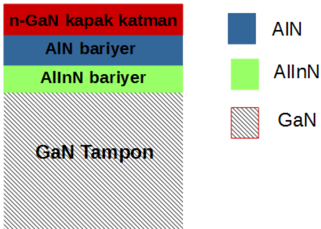
Şekil 5.45. n-GaN/AlN/AlInN/GaN ultraince bariyerli çokluyapısının (Yapı7) şematik gösterimi
