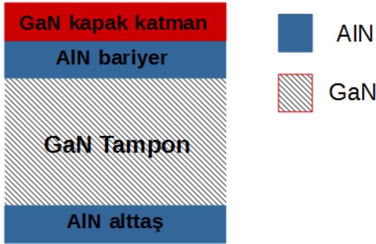
Şekil 5.67. GaN/AlN/GaN/AlN ultraince bariyerli çoklu yapısının (Yapı10) şematiği
