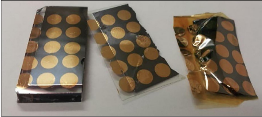
Şekil 3.5. Cam, ultra ince cam ve poliimid üzerindeki CdTe FV hücreler [39]
