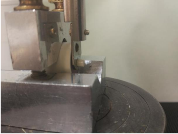
Resim 3.9. Bağlanma dayanımı testi öncesi sabitlenmiş örnekler
