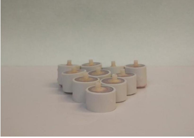
Resim 3.8. SBF’de bekletmek için hazırlanan örnekler
