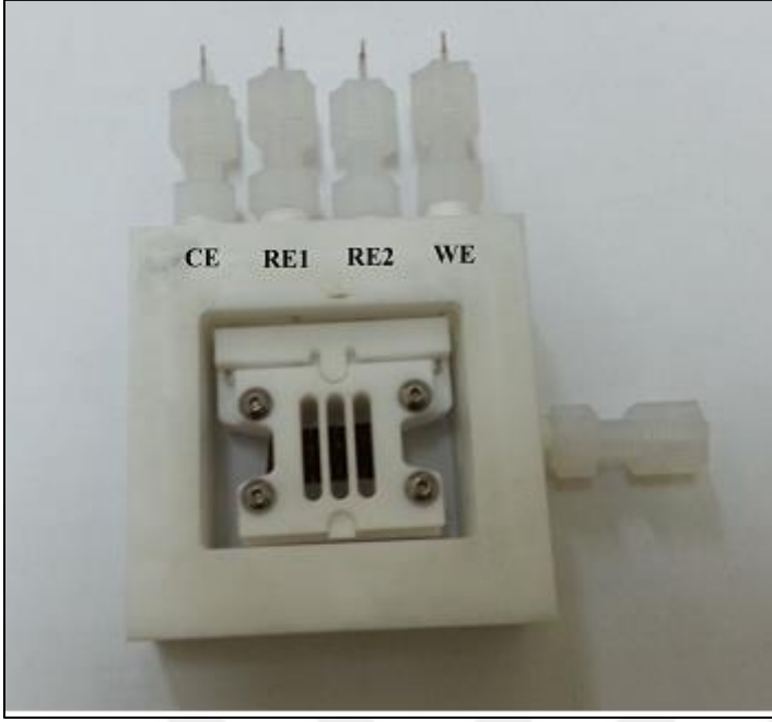
Şekil 4.9. 4 Proflu proton iletkenliđi ölçüm sistemi
