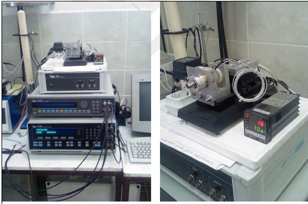
Şekil 4.8. Solartron 1296 - 1287 kombinasyonu ve ölçüm hücresi
