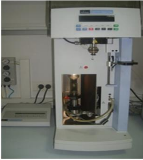
Resim 4.2. TGA analiz cihazı
