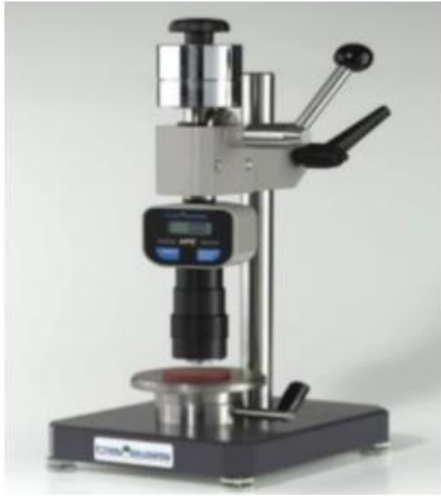
Resim 4.1. Shore D sertlik ölçme cihazı
