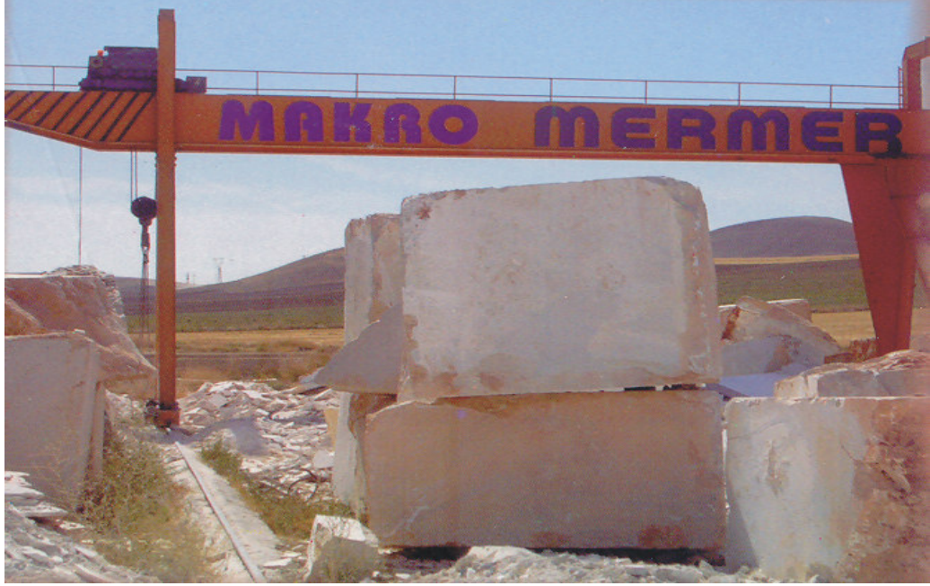
Resim 23.1. Mermer işleme tesisine getirilen blokların kayar vinç ile taşınması
