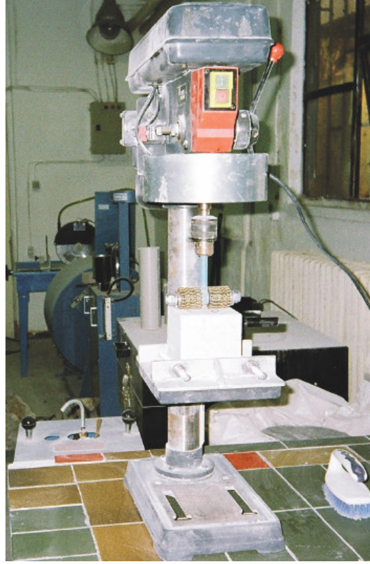
Resim 3.3. Tırnaklı dönen aşındırma aletine numunenin yerleştirilmesi
