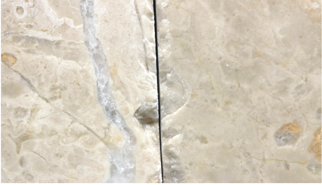
Resim 24.1. Açık hava tesirlerine dayanıklılık deney numuneleri I (sol taraf referans)
