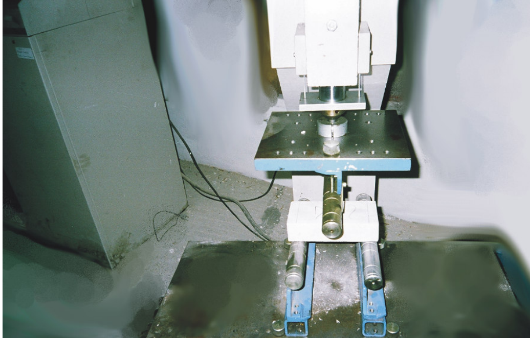
Resim 3.2. Eğilme mukavemeti ölçüm setine numunenin yerleştirilmesi
