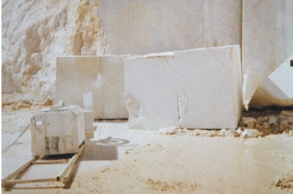
Resim 21.2. Elmas tel kesme makinesi ile büyük blokların standart boyutlara getirilmesi
