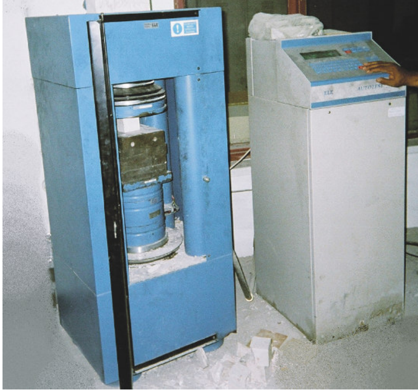
Resim 3.1. Basınç mukavemeti ölçüm setine numunenin yerleştirilmesi
