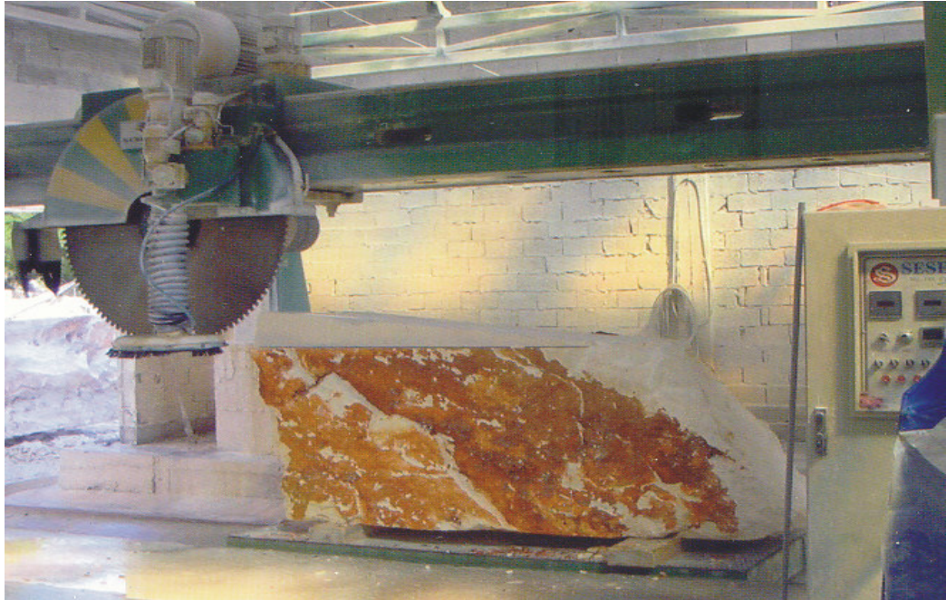
Resim 23.2. Blokların S -T (katrak) makinesi ile istenilen boyutta kesilmesi
