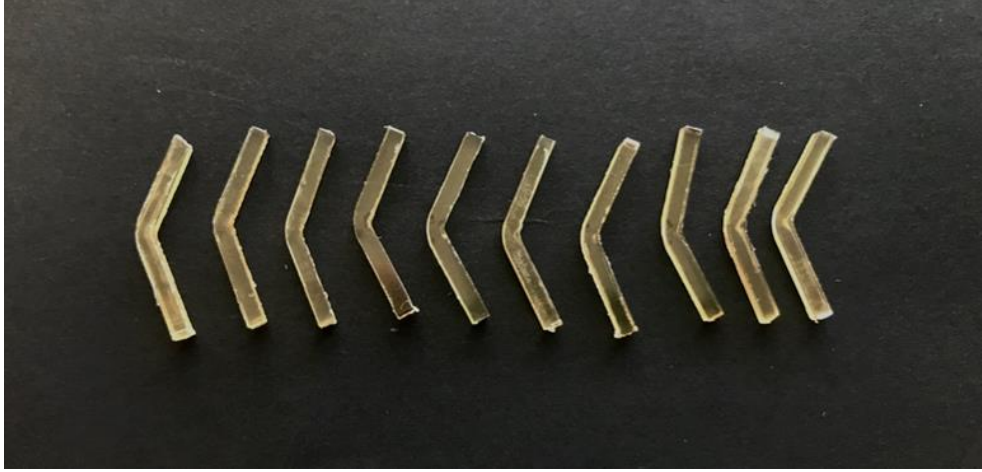
Resim 4.4. Test sonucunda plastik deformasyona uğrayan INJ-PPSU örnekleri
