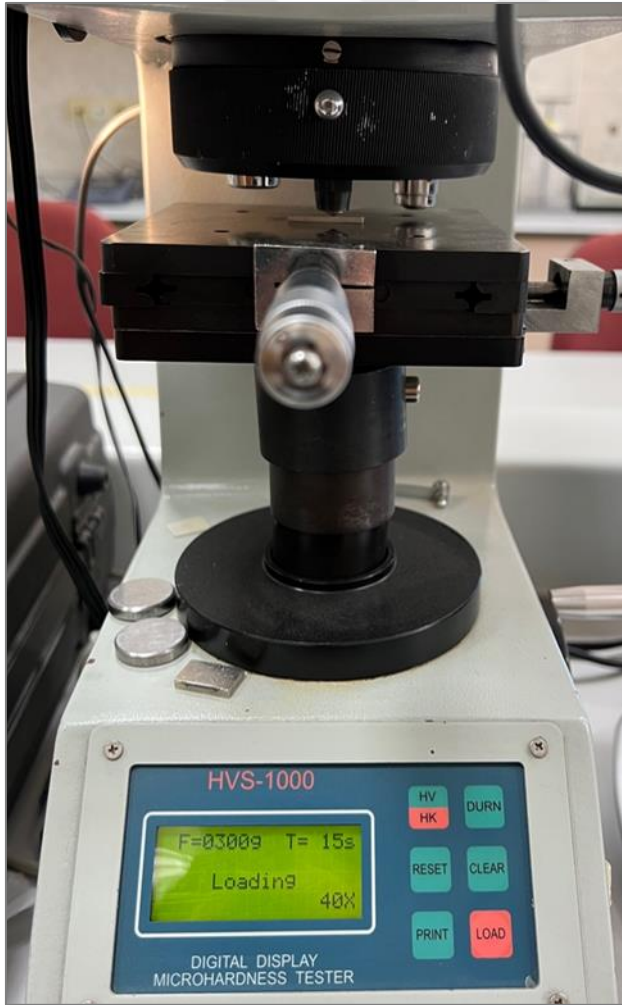
Resim 3.17. Vickers sertlik ölçüm cihazına test örneğinin yerleştirilmesi ve uygulanacak yük miktarı ve saniyenin ayarlanması
