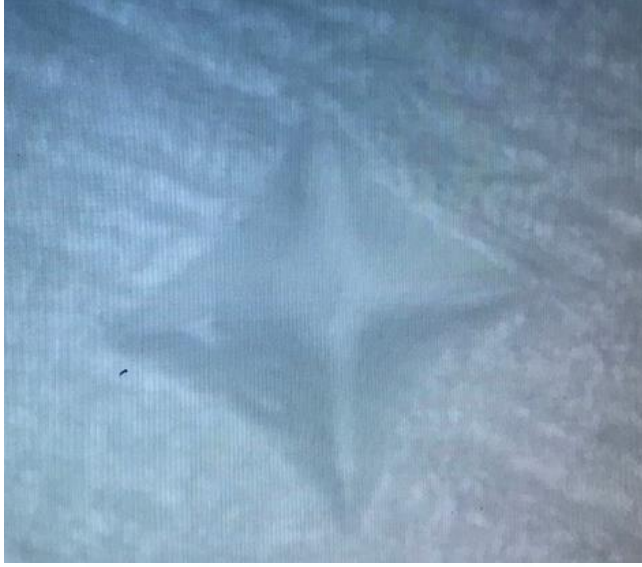
Resim 3.18. Vickers sertlik testi sonucu 3D-PPSU örnek yüzeylerinin görüntüsü
