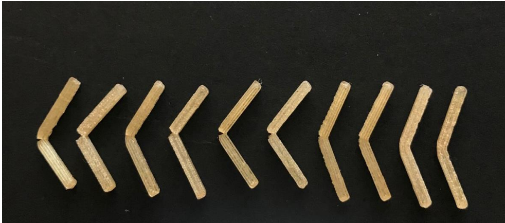
Resim 4.3. Test sonucunda plastik deformasyona uğrayan 3D-PPSU örnekleri
