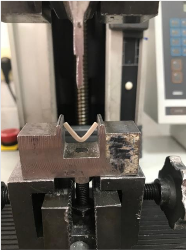
Resim 3.14. 3D-PEEK örneğine kuvvet uygulanması
