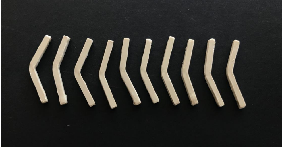
Resim 4.2. Test sonucunda plastik deformasyona uğrayan CAD/CAM-PEEK örnekleri
