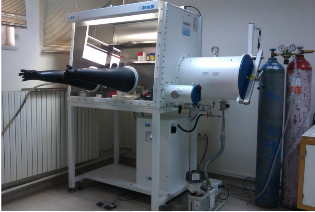
Resim 1.2. LABstar, MBRAUN marka Glove-Box Cihazı
