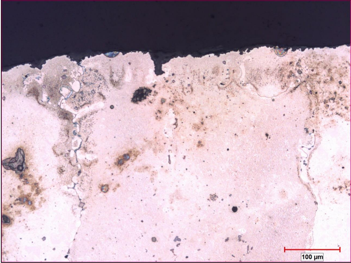
Şekil 5.8. CM247-LC tane sınırlarında ilerleyen korozyon ve kaplama yüzeyinde meydana gelen dökülmeler
