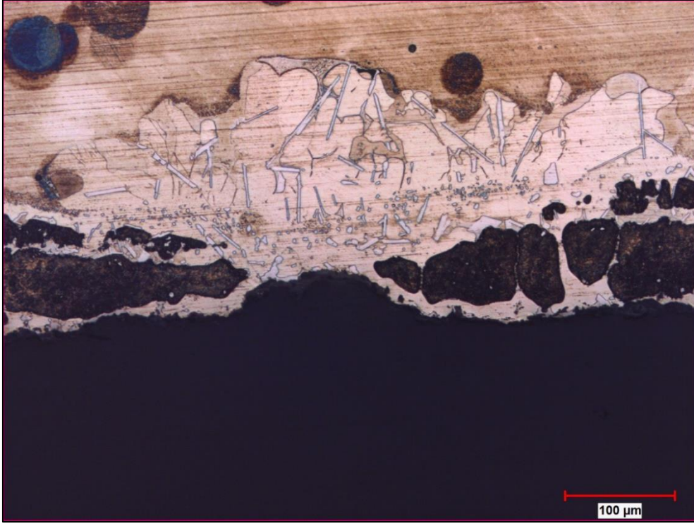
Şekil 5.6. CM247-LC Malzemede oluşmuş alüminyumca zengin iğnemsli oksit yapıları
