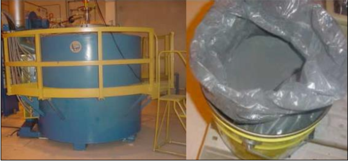
Şekil 3.6. CODEP kaplama sırasında kullanılan hidrojen fırını ve CODEP tozu [44]
