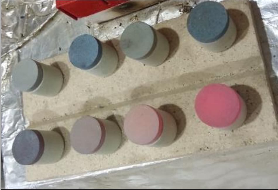
Şekil 4.10. Çevrimsel oksidasyon testi uygulanan soğuma evresindeki numuneler
