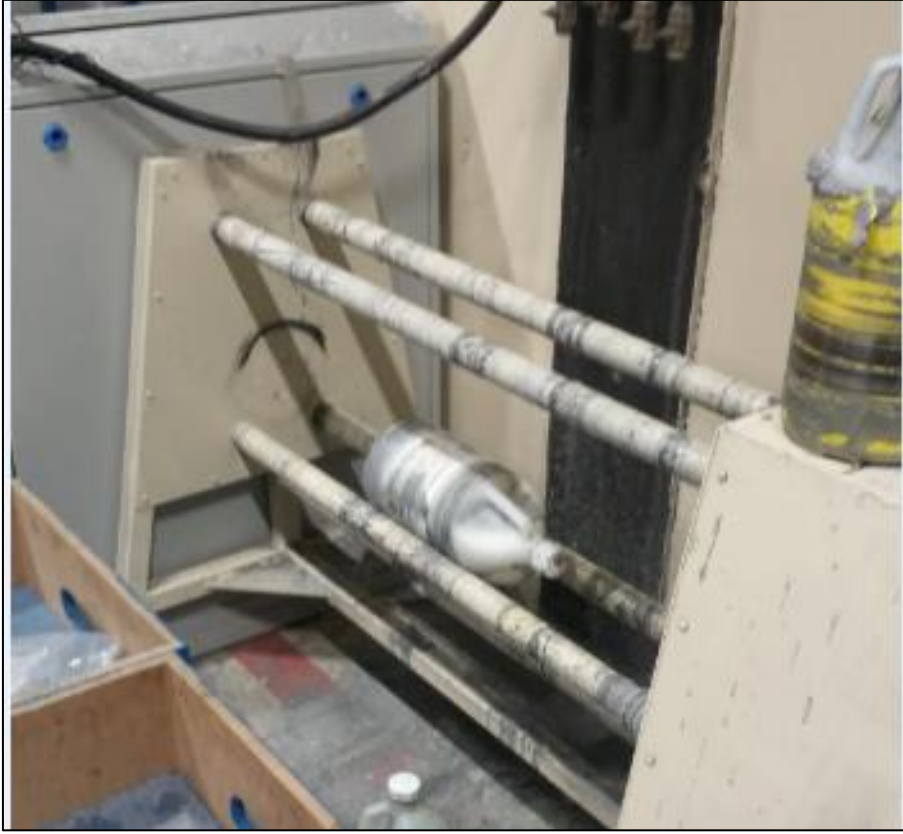
Şekil 4.4. Solüsyonun karıştırılmasını sağlayan döner rulo karıştırıcı
