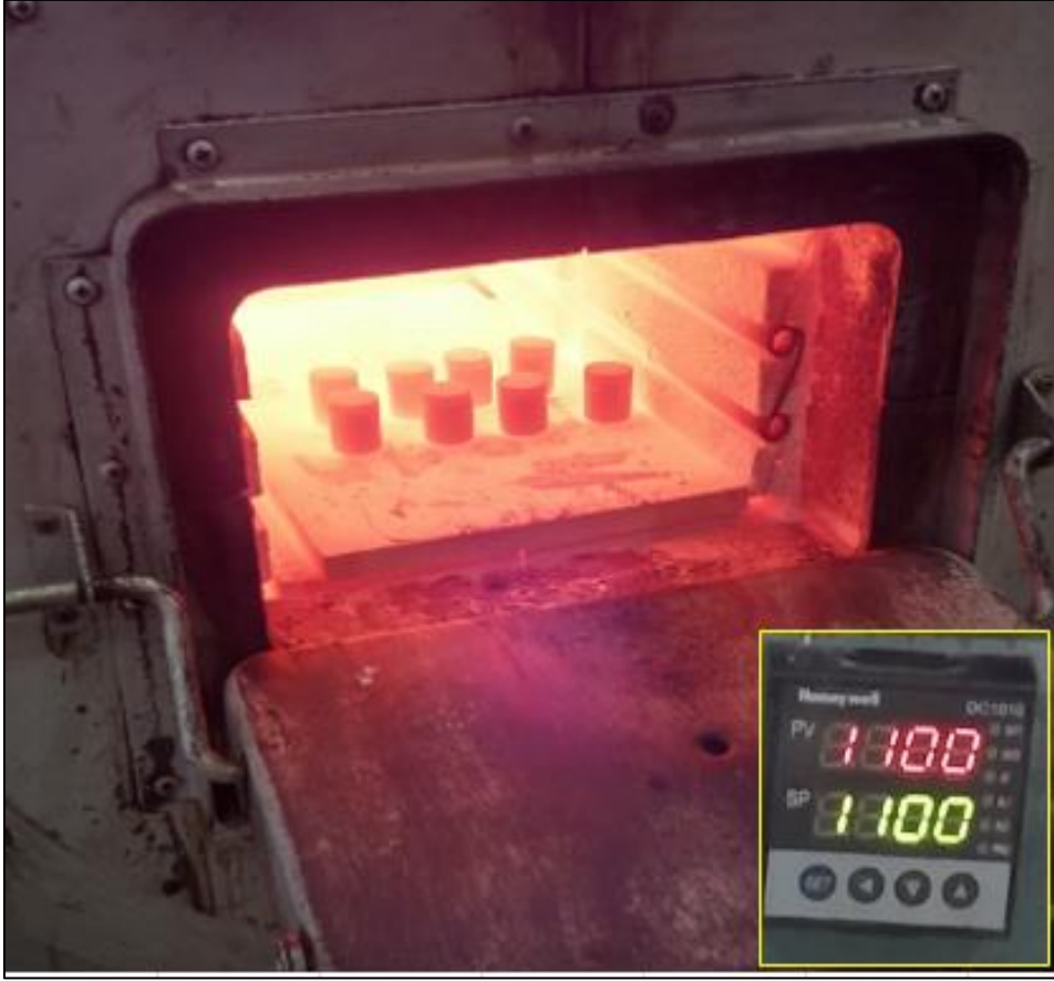
Şekil 4.9. Çevrimsel oksidasyon testinin gerçekleştirilmesinde kullanılan Heraus marka muffle tipi fırın ve test düzeneği
