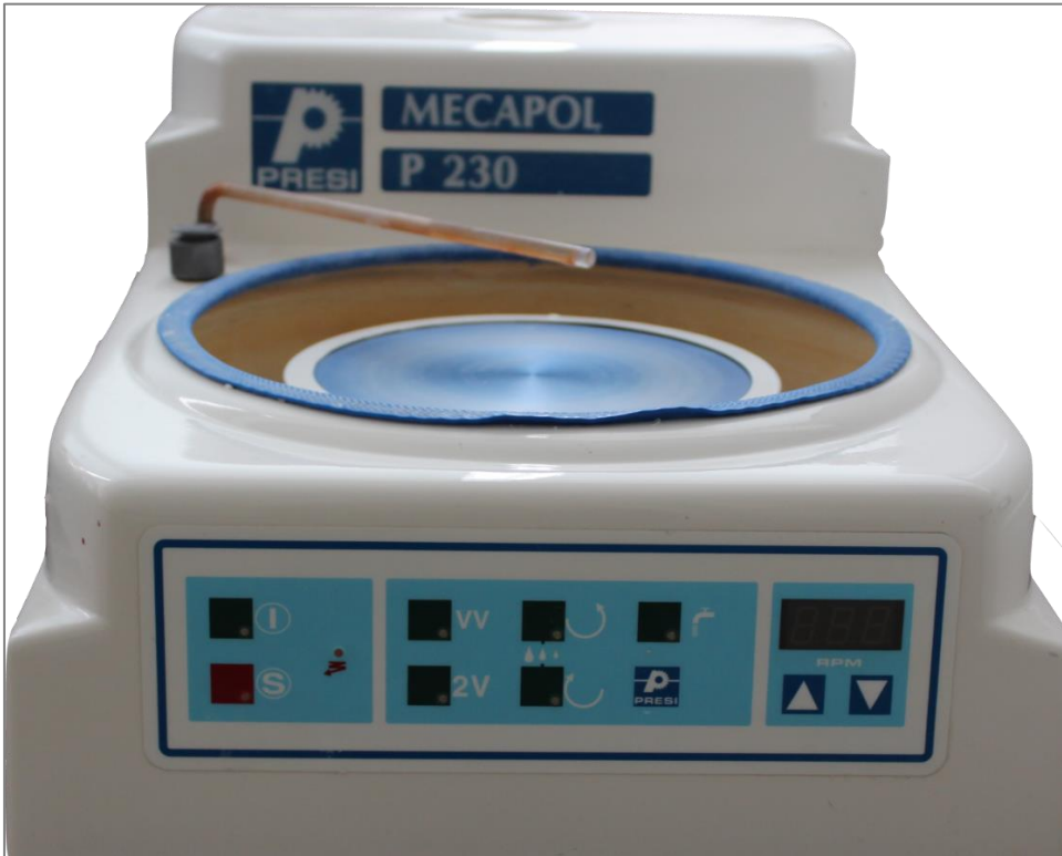
Resim 3.2. Zımparalama ve parlatma cihazı (Mecapol P230, Presi, Türkiye)
