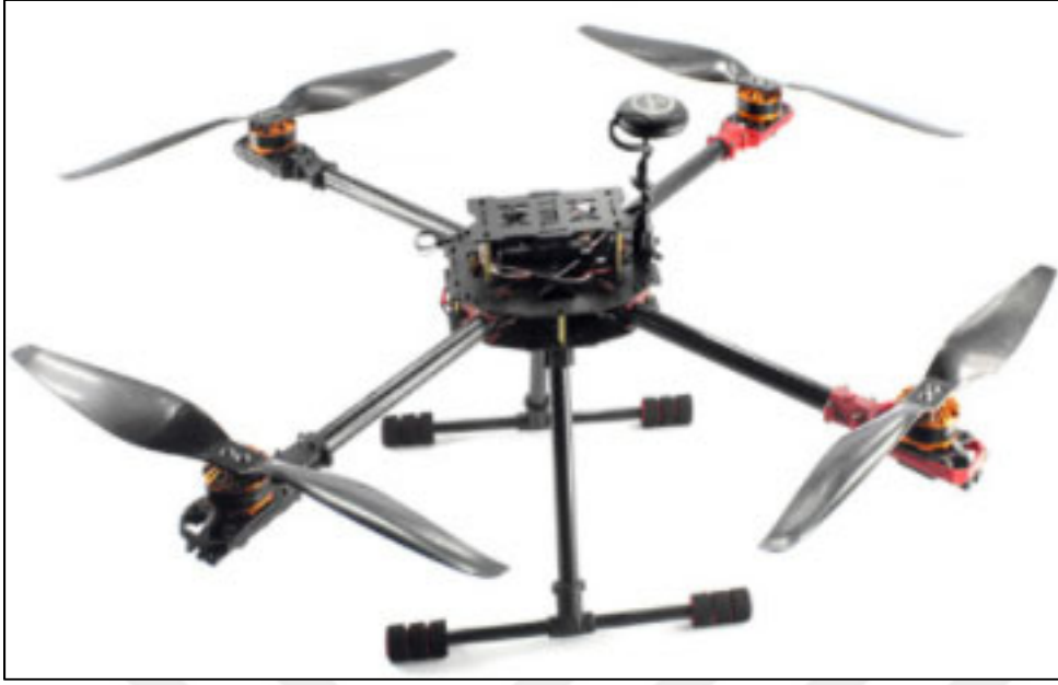
Şekil 5.3. Çokluuçarda kullanılan çerçeve
