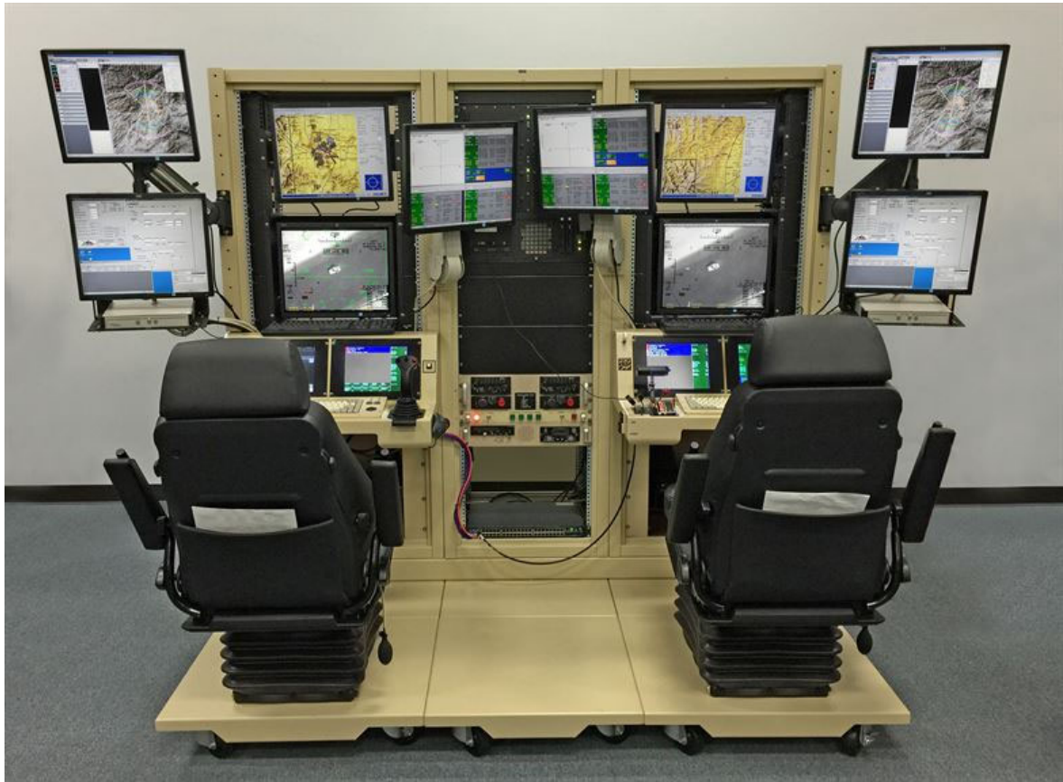
Şekil 5.15. Bir mobil yer kontrol istasyonu
