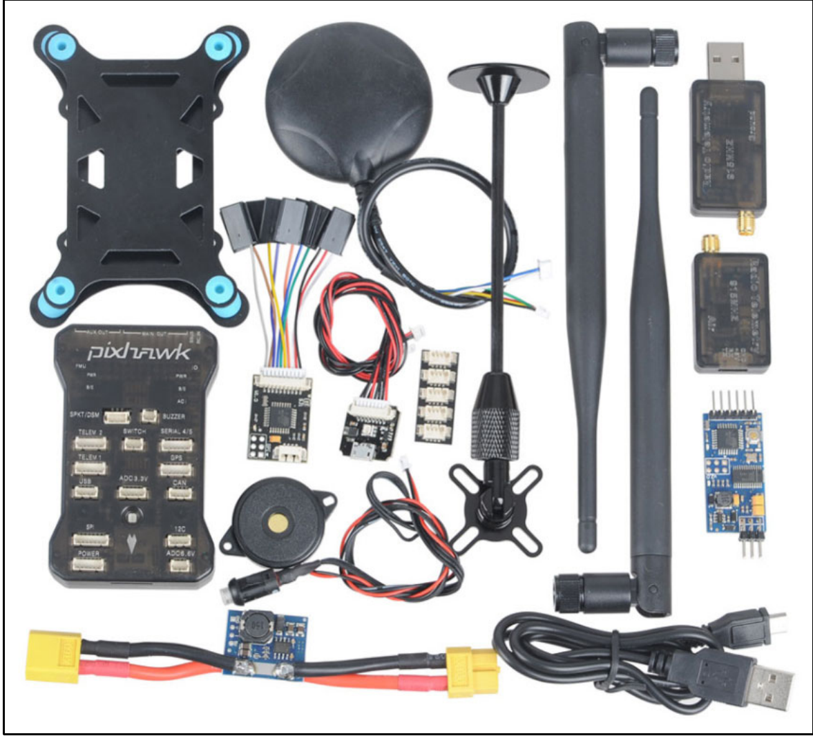
Şekil 5.2. Çokluuçarda kullanılan uçuş denetleyicisinin bileşenleri
