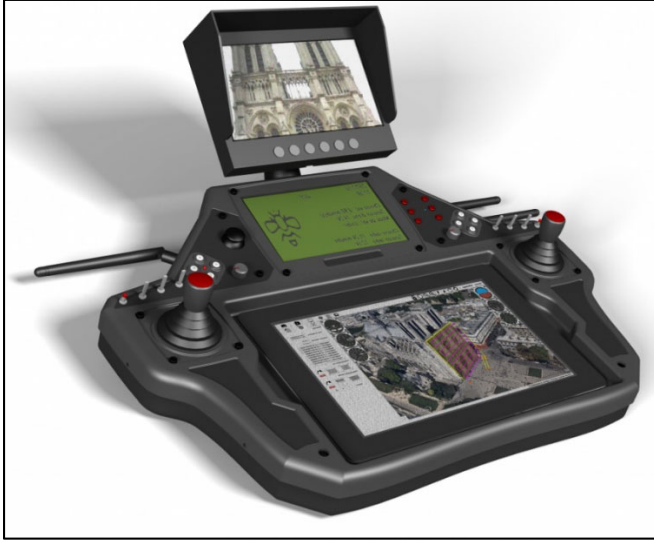
Şekil 5.12. Bir taşınabilir yer kontrol istasyonu
