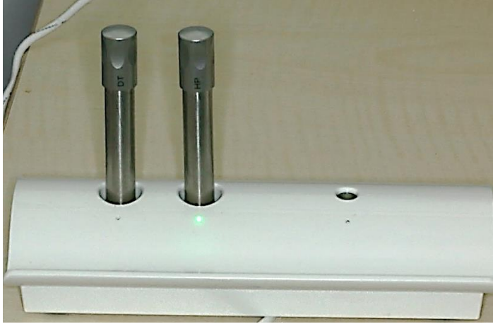
Resim 3.10. İki bataryaya sahip olan GC D-Light Pro LED ışık cihazının şarj ünitesi
