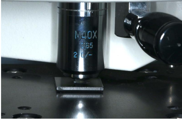
Resim 3.16. Vickers sertlik ölçüm cihazıyla oluşturulan iz düşümün x40 büyütmede incelenmesi
