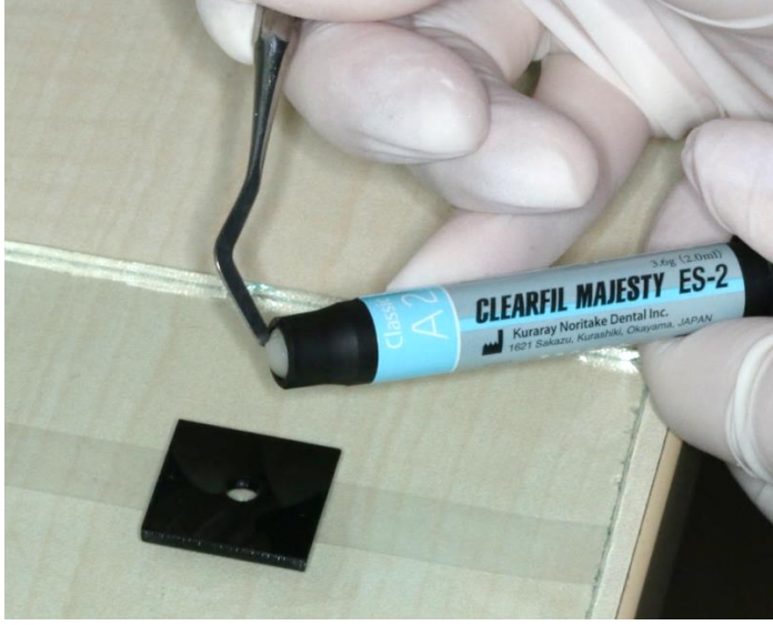
Resim 3.6. Kompozit rezin materyalin teflon kalıba yerleştirilmesi
