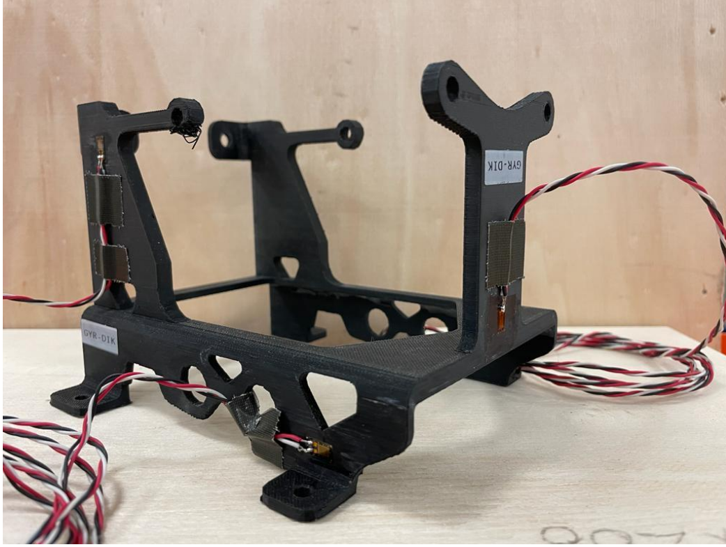
Resim 4.8. Gyroid dikey test numunesine gerinim ölçer uygulaması
