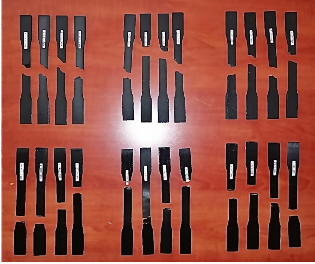
Resim 6.1. Test edilen tüm çekme numuneleri
