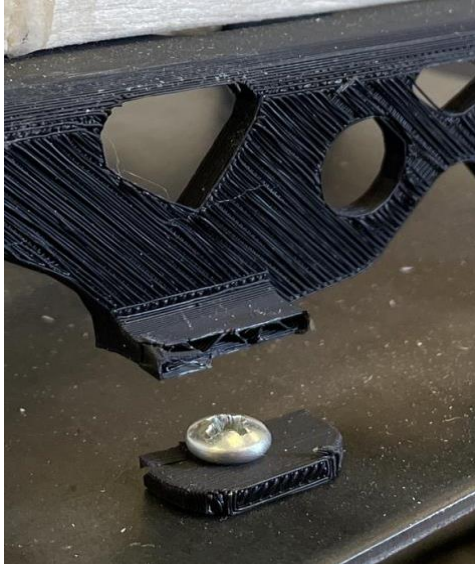
Resim 6.11. Rectilinear yatay test numunesinin kırılma yüzeyinin yakın çekimi
