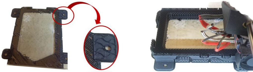
Resim 5.6. Dönel çizgili (gyroid) örme tipi ile dikey yerleşimli üretim
