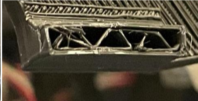
Resim 6.11. Rectilinear yatay test numunesinin kırılma yüzeyinin yakın çekimi
