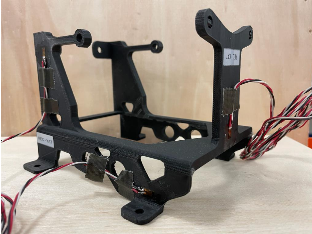
Resim 4.9. Rectilinear yatay test numunesine gerinim ölçer uygulaması
