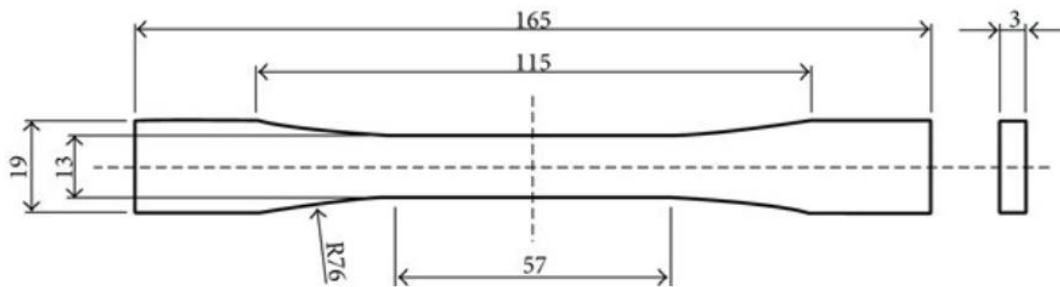
Şekil 5.1. ASTM D638 Type I numune ölçüleri
